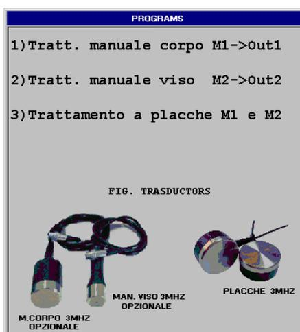
Assicurarsi di collegare i manipoli relativi al programma alle uscite indicate, ad esempio per il programma1 collegare il manipolo corpo 3mhz M1 alla uscita Out1.
