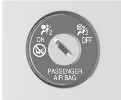
Il sistema airbag del passeggero anteriore può essere disattivato mediante una serratura sul lato del quadro strumenti, visibile quando la portiera del passeggero anteriore è aperta.
