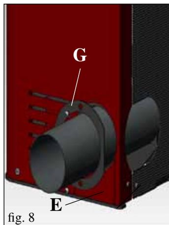
Completare l'operazione fissando il rosone di chiusura (G - fig. 8 - fornito optional cod. 684790) mediante viti.
