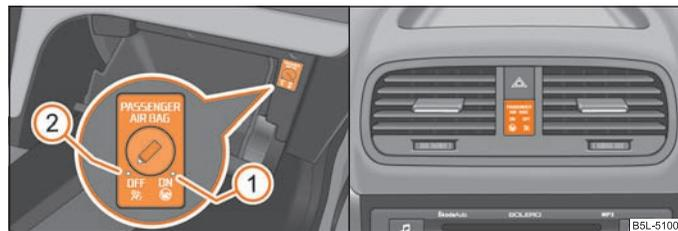
Fig. 142 Scomparto portaoggetti: Interruttore per airbag frontale lato passeggero / spia di controllo per disabilitazione airbag lato passeggero
