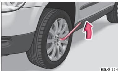
Fig. 181 Sostituzione di una ruota: Allentamento dei bulloni
