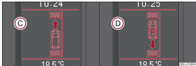
Fig. 116 Display informativo: Avvertenza per l'innesto della marcia in avanti (C) o della retromarcia (D)
