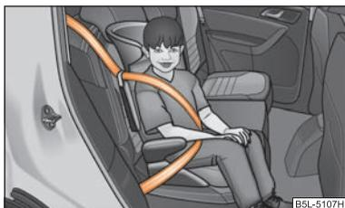
Fig. 146 Seggiolino per bambini del gruppo 2 montato nel senso di marcia sul sedile posteriore
