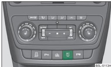
Fig. 152 Tasto per la regolazione del valore di controllo per la pressione dei pneumatici
