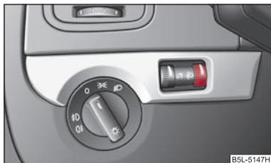
Fig. 41 Plancia: Regolazione assetto fari
