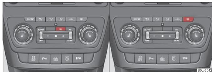
Fig. 48 Interruttore riscaldamento parabrezza / interruttore lunotto termico
