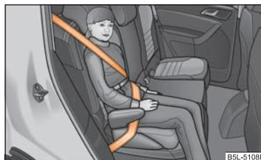
Fig. 147 Seggiolino per bambini del gruppo 3 montato nel senso di marcia sul sedile posteriore
