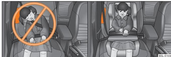
**Fig. 143** Bambino non assicurato correttamente e con posizione sedile non corretta - pericolo rappresentato dall'airbag laterale / bambino seduto correttamente in un seggiolino
