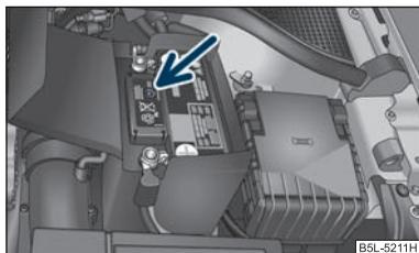
Fig. 171 Batteria: Indicazione del livello dell'elettrolito
