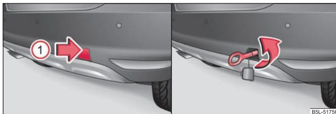
Fig. 188 Paraurti posteriore: Smontaggio della copertura / Montaggio dell'occhione di traino
