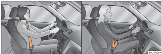
Fig. 131 Posizione del nastro della cintura per le donne incinte / posizione del nastro diagonale e del nastro addominale della cintura
