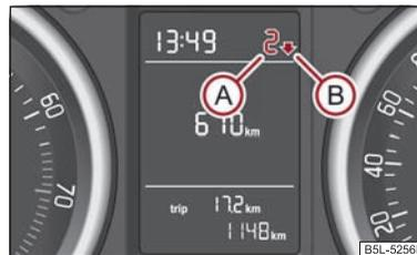
Fig. 17 Suggerimento per il passaggio di marcia
