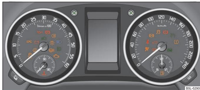
Fig. 21 Strumento combinato con spie di controllo
