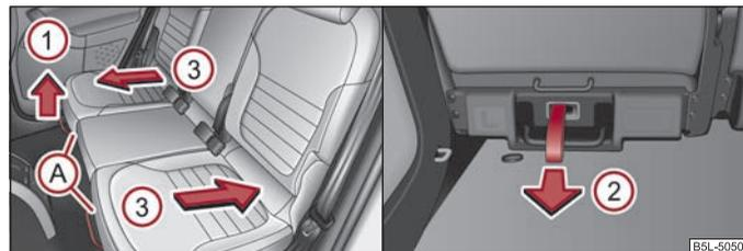
Fig. 62 Sbloccaggio anteriore / posteriore
