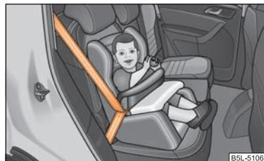
Fig. 145 Seggiolino per bambini del gruppo 1 con tavolino di sicurezza montato nel senso di marcia sul divano posteriore
