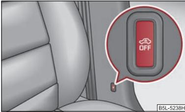
Fig. 31 Tasto della sorveglianza abitacolo e della protezione antirimozione
