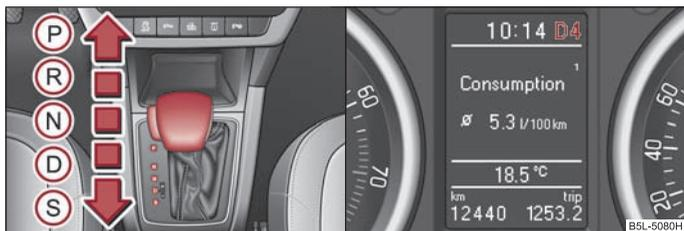
Fig. 119 Leva selettoria / display informazioni: Posizioni della leva selettoria
