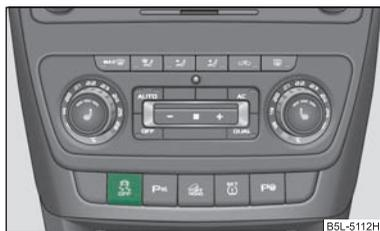
Fig. 150 Sistema ESP: Interruttore ASR
