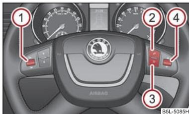
Fig. 125 Volante multifunzione: Uso del telefono
