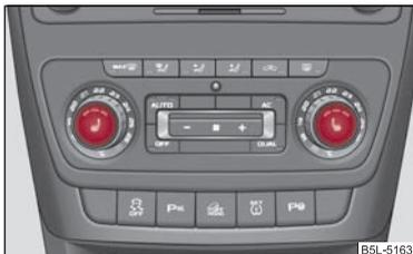
Fig. 69 Plancia: Regolatore riscaldamento sedili anteriori
