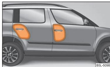
Fig. 139 Airbag laterale riempito con gas
