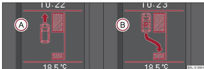
Fig. 115 Display informativo: area di parcheggio rilevata con indicazione a procedere la marcia (A) e innesto della retromarcia (B)
