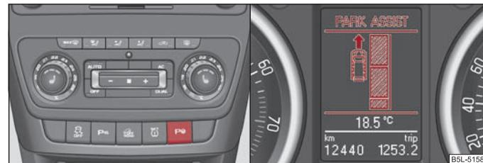
Fig. 114 Inserimento dell'assistenza al parcheggio / display informazioni: Trovare un'area di parcheggio adatta
