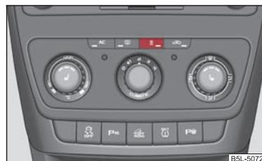
**Fig. 106** Tasto per l'inserimento/disinserimento diretto del riscaldamento supplementare (riscaldamento e ventilazione autonomi) sul pannello comandi del climatizzatore
