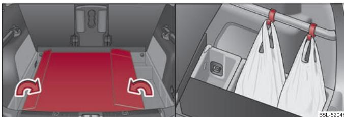
Fig. 78 Bagagliaio: ribaltare i lati del piano di carico / esempio per l'utilizzo del piano di carico variabile
