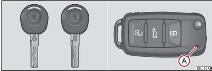
Fig. 22 Set di chiavi senza telecomando / chiave con chiave con comando a distanza
