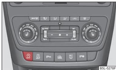
Fig. 118 Plancia: tasto del sistema START-STOP
