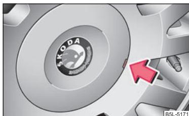
Fig. 180 Rimozione delle coppe con ruote con cerchi in lega
