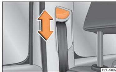
Fig. 132 Sedile anteriore: Regolazione dell'altezza della cintura
