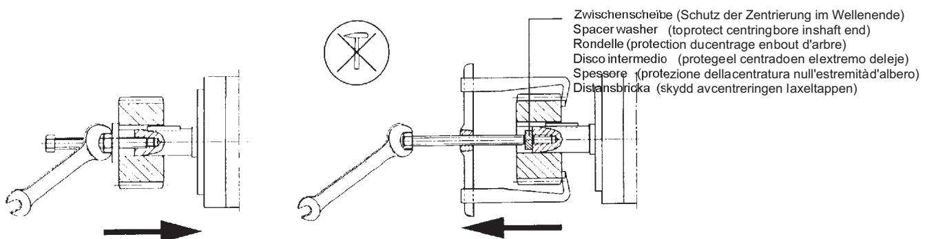
Zum Aufziehen von Abtriebselementen (Kupplung, Zahnräder, Riemenscheibe usw.), Gewinde im Wellenende benutzen und - sofern möglich - Abtriebselemente nach Bedarf erwärmen. Zum Abziehen geeignete Vorrichtung verwenden. Es dürfen beim Auf- und Abziehen keine Schläge (z.B. mit Hammer oder ähnlichem) oder größere als die laut Katalog zulässigen radialen oder axialen Kräfte über das Wellenende auf die Motorlager übertragen werden.
