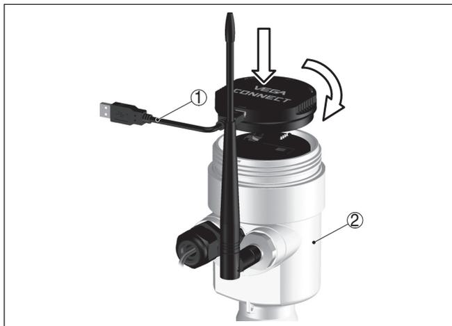
Figura 14: Installazione e collegamento in un apparecchio plics®
