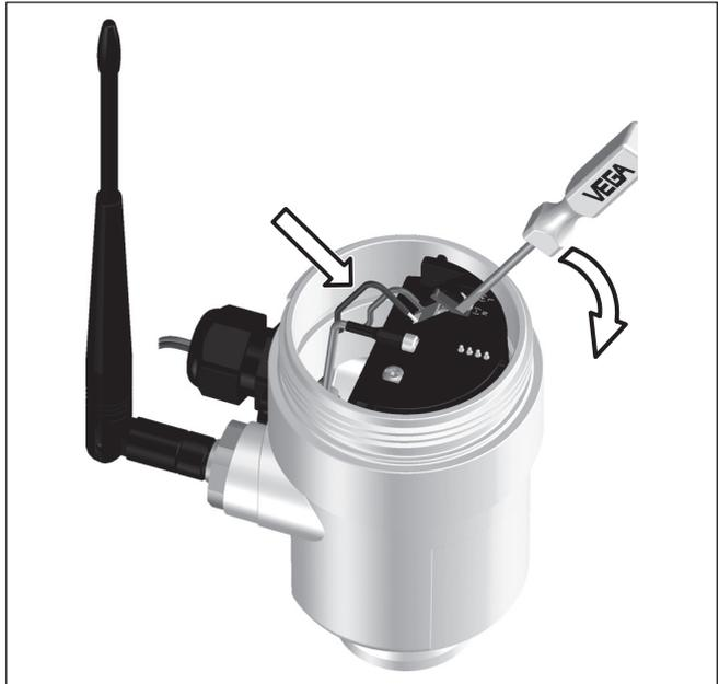
Figura 8: Passi 6 e 7 (collegamento dell'alimentazione in tensione)
