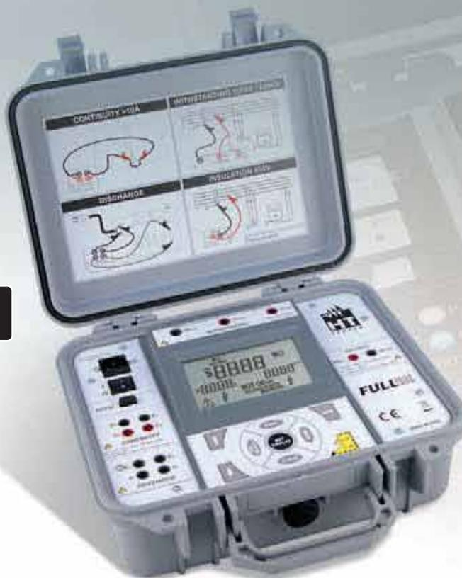
**Resistenza su conduttori di protezione con I>10A, V<12VAC**
