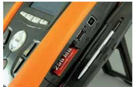
Inserimento di Compact Flash per estensione della memoria, Pen Driver USB possono inoltre essere usati per il trasferimento delle registrazioni
