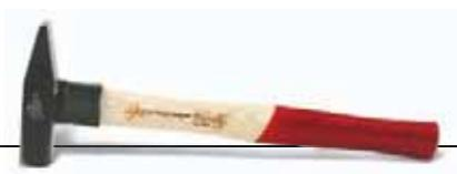
Tipo tedesco brevettato con collare salvamanico di sicurezza. In acciaio C45 temprato ad elettro-induzione. Levigato lateralmente e verniciato a forno. Battenti spigolati e lucidi. Bussola salvamanico, manico in frassino sagomato, bloccaggio con cuneo in acciaio e resina epossidica.
