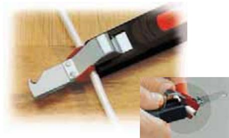
Preciso, veloce ed affidabile per spellare cavi circolari di diametro 4-28 mm<sup>2</sup>. Dotato di adattatore asportabile in plastica di elevata resistenza (POM). Grazie al dispositivo di regolazione variabile della profondità di taglio non danneggia i conduttori interni.
