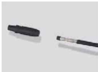
Preparare il connettore MC3 crimpato e il connettore isolante (maschio o femmina)
