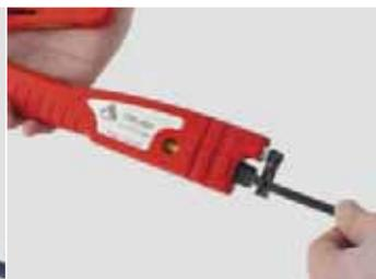
Pressare la pinza fino a che il mandrino non è completamente inserito nel connettore ed inserire il cavo crimpato fissandolo con l'apposito blocca cavo.
