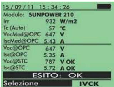
Test rapido IVCK: misura della tensione Voc e della corrente Isc su moduli e stringhe FV
