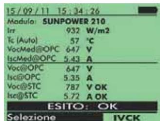
Test rapido IVCK: misura tensione Voc e corrente Isc su moduli e stringhe FV
