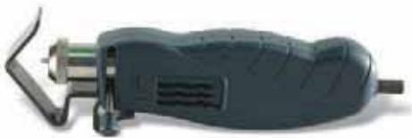
Pelacavo autoregolabile ad azione rotante, adatto ad ogni tipo di guaina isolante consente di effettuare tagli circolari, elicoidali e longitudinali. Consente di effettuare anche spellature interne. Per cavi fino a 25 mm<sup>2</sup>
