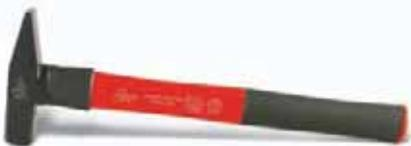
Specifici per installatore con collare salvamanico di sicurezza. In acciaio C45 temprato ad elettro-induzione. Levigato lateralmente e verniciato a forno. Battenti spigolati e lucidi. Manico brevettato tricomponente: Nylon, impugnatura a bussola salvamanico in gomma antiscivolo, anima in lega d'alluminio, bloccaggio con cuneo in acciaio e resina epossidica.
