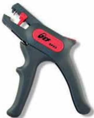
Semplice ed affidabile questo spellacavi permette di spellare fili con isolamento in PVC da 0,03 fino a 6mm<sup>2</sup>/AEG 30-10a. Lunghezza regolabile da 3 fino a 16 mm. È in grado di tagliare fili multipli, cavi di trasmissioni dati e cavi telefonici a 4-6-8 poli. Leggero e semplice da azionare, basso impiego di forza grazie al design ergonomico.
