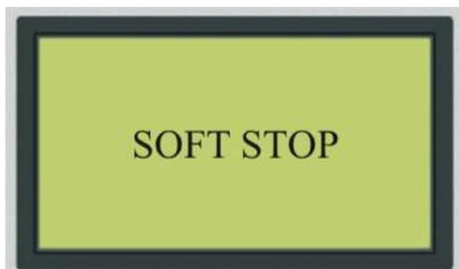
**Motivo:** Il disegno da lavorare è più grande delle dimensioni massime del piano di lavoro, oppure il punto di posizionamento (origine) è errato. La macchina prima di iniziare la lavorazione calcola l'area di ingombro del disegno rispetto allo spazio utile sul piano di lavoro; se questo è superiore, non inizia il lavoro e avvisa l'operatore con questo messaggio di errore.
