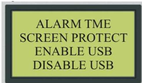
**ALARM TIME:** Funzione che permette di impostare il tempo di avviso a fine ciclo di lavorazione. (la macchina emette un avviso sonoro a termine lavorazione di durata (s) uguale al valore impostato).
