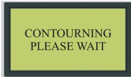
**Test:** Premuto in questa fase, fa eseguire alla macchina una traccia dell'area massima di ingombro relativa al disegno selezionato. Questa funzione consente all'operatore un corretto posizionamento della macchina sul materiale da lavorare. Durante il test di ingombro sullo schermo compare il messaggio mostrato in figura; tutti i tasti sul pannello sono disabilitati ad eccezione del tasto "STOP" che permette l'arresto dell'antepima prima del suo completamento.
