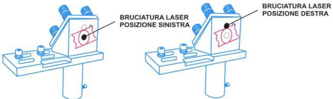
Quando invece, il risultato del test è come quello mostrato sopra, vuol dire che il raggio proiettato dal secondo specchio non è perfettamente allineato lungo la corsa del carrello, quindi è necessario operare sulle regolazioni del secondo specchio per poter correggere il problema.
