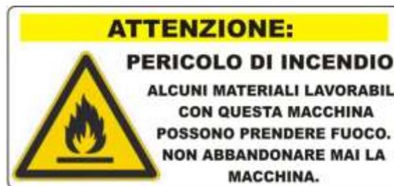
L'incisione e il taglio laser rappresentano un significativo rischio di incendio. Molti materiali in commercio sono potenzialmente infiammabili; il laser lavora su diversi materiali vaporizzando il supporto mediante bruciatura; questa polvere o gas generato dalla bruciatura può dar vita a delle piccole fiamme lungo il percorso di taglio che generalmente si auto-estinguono quando la macchina termina il lavoro.
