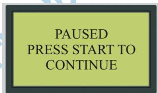
**Start/Pause:** Permette all'operatore di mettere in pausa la lavorazione per poter meglio controllare lo svolgimento della lavorazione.
