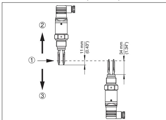
Figura 2: Montaggio verticale
