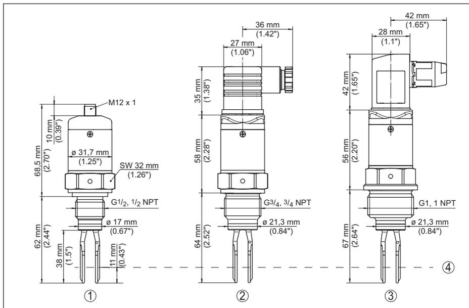
Figura 33: VEGASWING 51, esecuzione standard - filettatura
