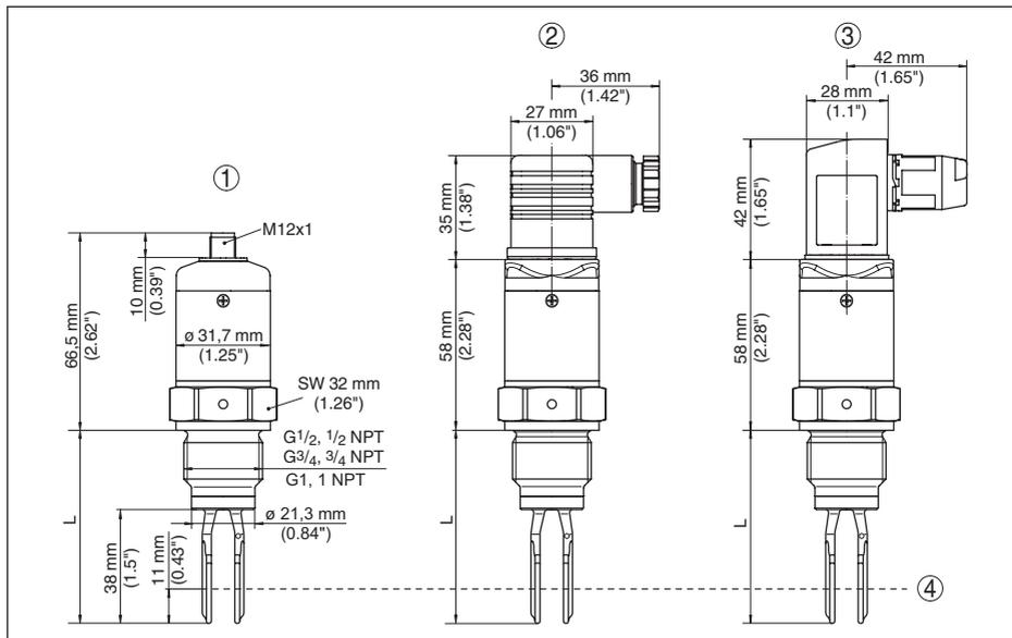
Figura 34: VEGASWING 51, esecuzione standard - filettatura G $\frac{3}{4}$ , G1,  $\frac{3}{4}$  NPT, 1 NPT
