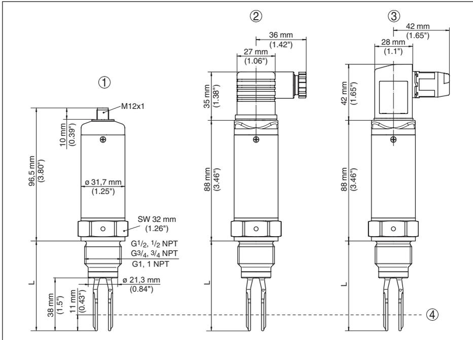
Figura 35: VEGASWING 51, esecuzione per temperatura elevata
