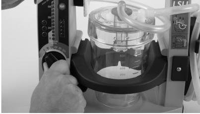
**Nota:** Non rilasciare il pulsante TEST prima che siano trascorsi min. 2 secondi dall'impostazione della manopola di funzionamento sul valore 500+ mmHg. Il test si avvia immediatamente.
