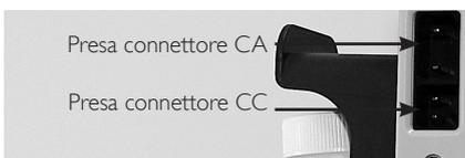
Il collegamento all'alimentazione esterna determinerà l'accensione della spia di alimentazione esterna. Controllare che la spia si accenda quando si collega il dispositivo all'alimentazione esterna o quando si posiziona l'aspiratore Laerdal sulla staffa di supporto a parete.
