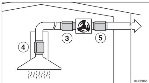
Per ridurre al massimo il rumore del ventilatore in cucina, l'insonorizzatore va installato direttamente prima del ventilatore esterno ③; se il tubo di sfiato è piuttosto lungo, presso il manicotto di sfiato della cappa aspirante ④. Se il ventilatore esterno viene installato in casa, l'insonorizzatore va sistemato dopo il ventilatore esterno ⑤ per ridurre i rumori del ventilatore verso l'esterno.
