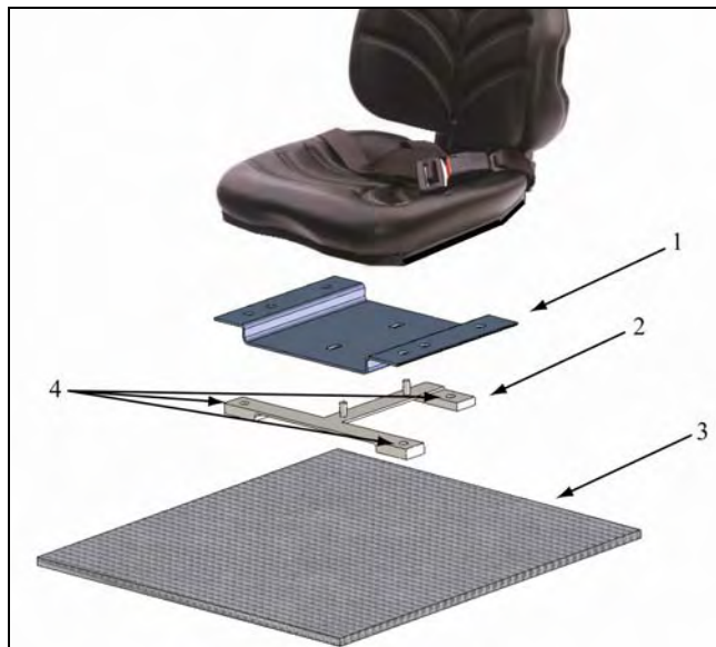
Figura 12 - Esempio di staffa a tre punti di attacco (1 piastra del nuovo sedile, 2 staffa di collegamento, 3 struttura portante del trattore, 4 punti attacco della staffa alla struttura portante del trattore)
