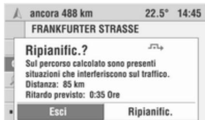
Con la guida dinamica la situazione attuale del traffico stradale, che viene ricevuta dall'Infotainment System attraverso RDS-TMC, viene integrata nel calcolo del percorso.
