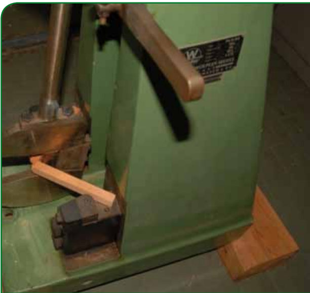
> Foto 12 - Martello di Charpy, per le prove a flessione dinamica (resilienza)
