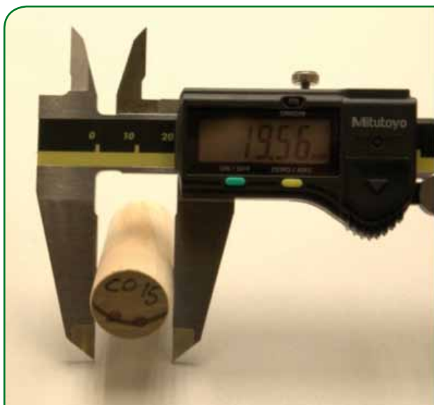
> Foto 9 - Misurazione dimensionale dei provini cilindrici non normalizzati per la caratterizzazione fisica
