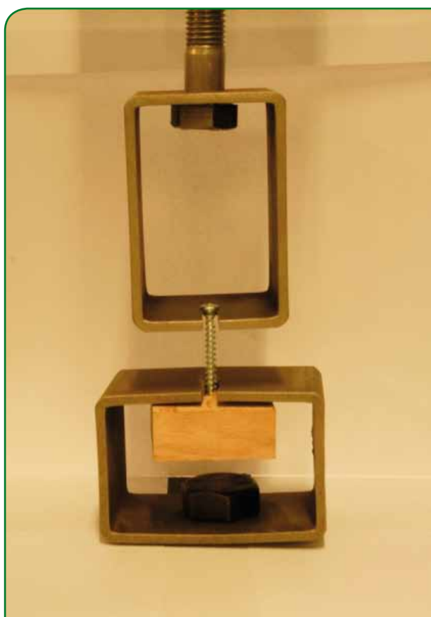
> Foto 15 - Afferraggi per la prova di resistenza all'estrazione della vite
