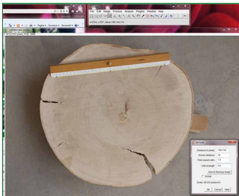
> Foto 8 – Rotella di Frassino equilibrata allo stato normale: sulle rotelle sono state prima effettuate le misurazioni morfologiche e poi sono state segate per ricavare i provini per la caratterizzazione fisica
