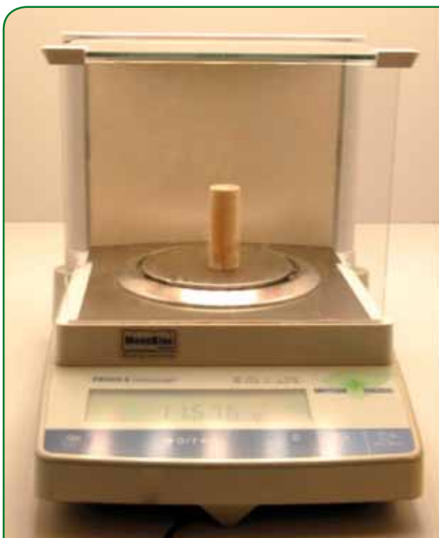
> Foto 10 - Pesatura dei provini cilindrici non normalizzati per la caratterizzazione fisica
