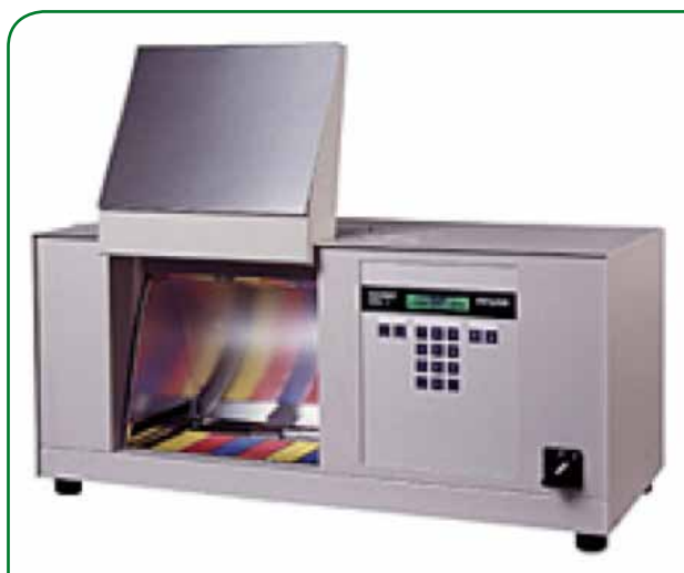
> Foto 16 - Apparato di prova per le prove di invecchiamento artificiale
