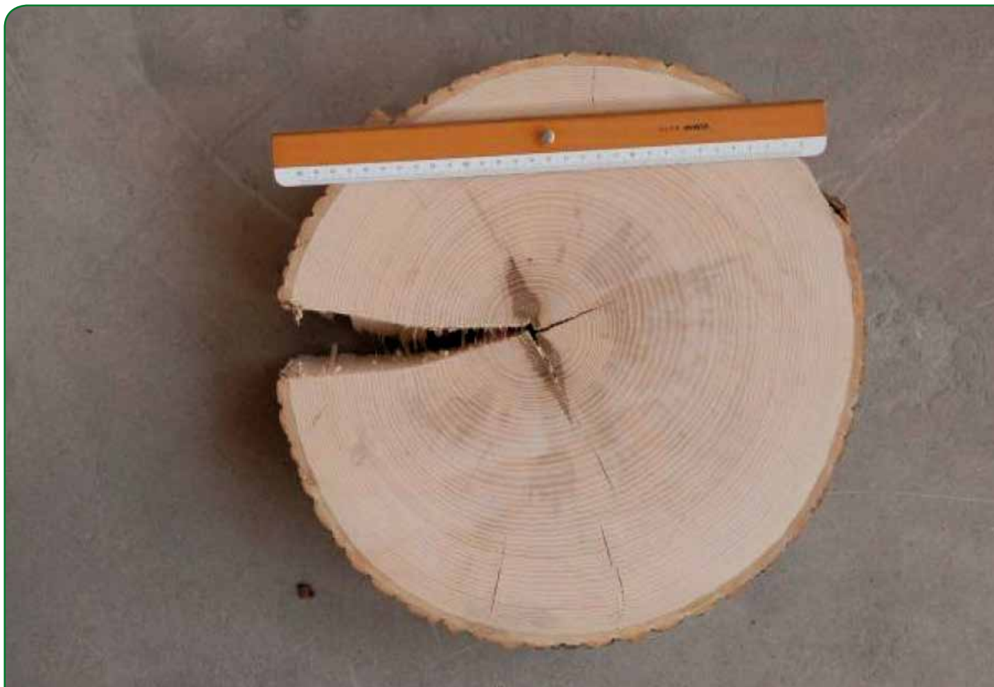
> Foto 8 – Rotella di Frassino equilibrata allo stato normale: sulle rotelle sono state prima effettuate le misurazioni morfologiche e poi sono state segate per ricavare i provini per la caratterizzazione fisica
