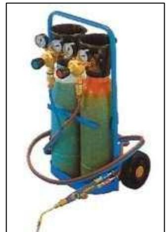
Saldatura portatile ossigeno acetilene
