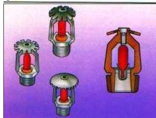
apertura delle teste erogatrici: per fusione di un elemento metallico o per rottura, a determinate temperature, di un elemento termosensibile a bulbo che consente in tal modo la fuoriuscita d'acqua.
