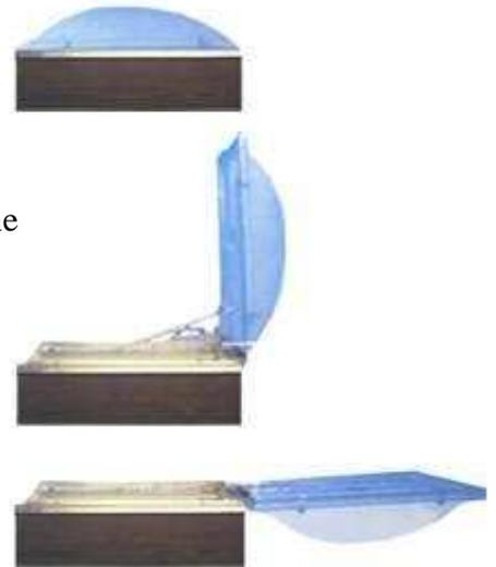
*Gli EFC devono essere installati, per quanto possibile, in modo omogeneo nei singoli compartimenti, a soffitto in ragione, ad esempio, di uno ogni 200 m<sup>2</sup> (su coperture piane o con pendenza minore del 20 %) come previsto dalla regola tecnica di progettazione costituita dalla norma UNI - VVF 9494.*
