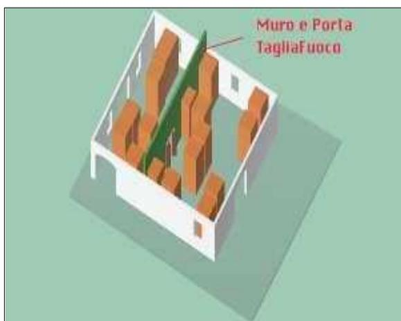
La determinazione della resistenza al fuoco delle strutture si effettua generalmente mediante un metodo di calcolo globale che si basa su una relazione tra la durata presumibile dell'incendio e il carico d'incendio che caratterizza il compartimento in esame, facendo inoltre riferimento ad un incendio con una curva standard temperatura-tempo di regola piuttosto severa rispetto alle possibili condizioni reali.
