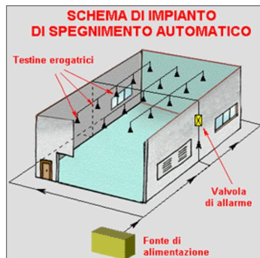
Un **impianto automatico di estinzione ad acqua Sprinkler** consta di più parti:
