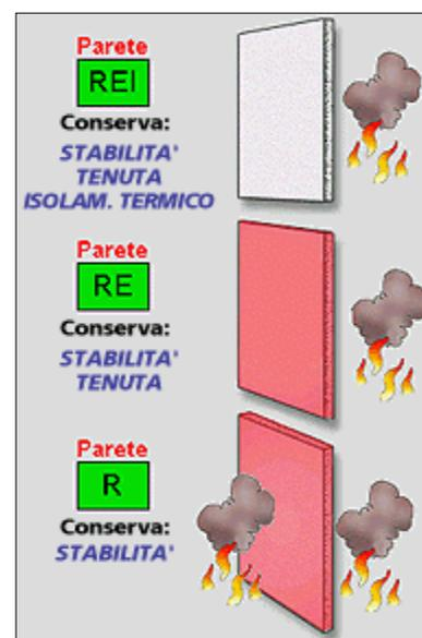
Le barriere antincendio realizzate mediante interposizione di elementi strutturali hanno invece la funzione di impedire la propagazione degli incendi sia lineare (barriere locali) che tridimensionale (barriere totali) nell'interno di un edificio, nonché, in alcuni casi, quella di consentire la riduzione delle distanze di sicurezza.
