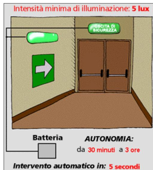
In caso di impianto alimentato da gruppo elettrogeno o da batterie di accumulatori centralizzate sarà necessario posizionare tali apparati in luogo sicuro, non soggetto allo stesso rischio di incendio della attività protetta; in questo caso il relativo circuito elettrico deve essere indipendente da qualsiasi altro ed essere inoltre protetto dai danni causati dal fuoco, da urti, ecc.
