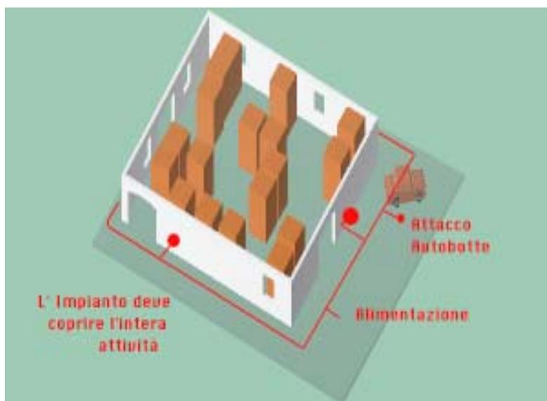
Le caratteristiche che una rete di idranti deve avere e le modalità con le quali deve essere realizzata e gestita sono fissate dalla **norma UNI 10779**.
