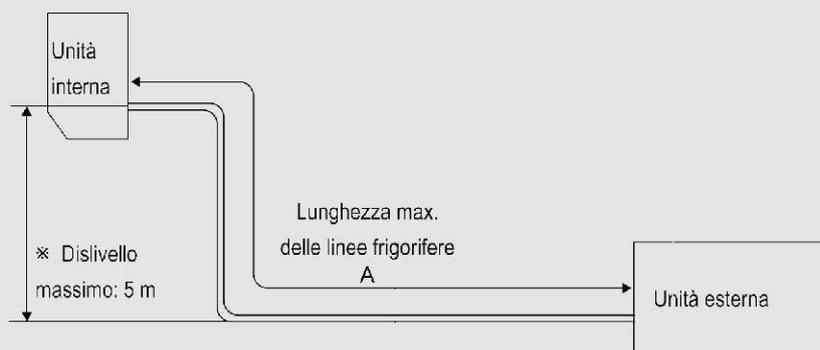
**ATTENZIONE:** E' sempre necessario intervenire ogni 4 m di altezza sulle tubazioni del refrigerante, con una piegatura delle tubature a "collo d'oca", in questo modo si previene la rottura del compressore, che può essere scaturita da una mancanza di lubrificazione, dovuta dal dislivello di lavoro tra unità interna ed unità esterna.
