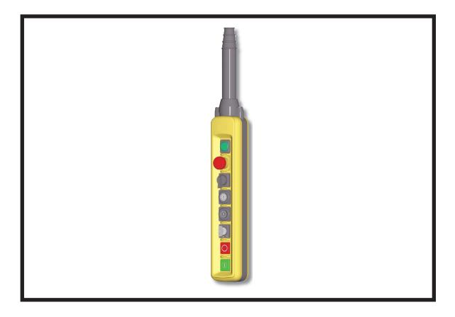
La pulsantiera NPA è un apparecchio utilizzato per il comando di qualsiasi macchina industriale. Essendo un comando ausiliario, interviene sul motore della macchina attraverso un'interfaccia di potenza, come un contattore o un PLC. È un comando industriale, non civile, in quanto è studiato per uso pesante.
