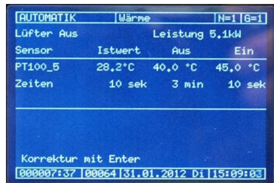
Fig. 23 Schermata menù "Impostazioni ventilatore" ("Lüfter-Einstellungen")
