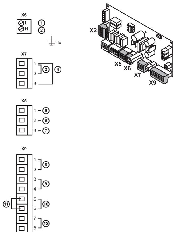
Dettagli dei terminali di collegamento esterno della caldaia
