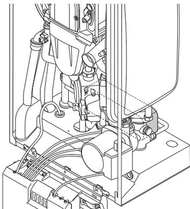
Pulizia dello scambiatore di calore a piastre e della valvola antiriflusso con filtro
