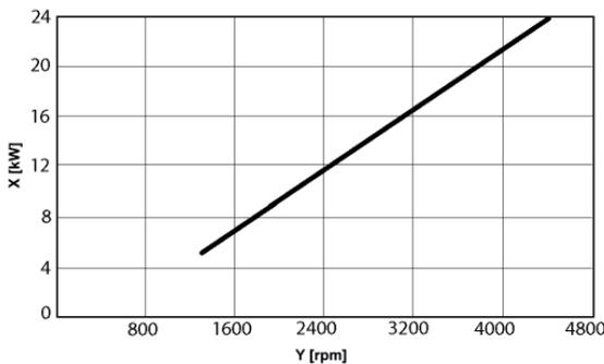
Rapporto velocità ventilatore / potenza erogata caldaia ModuStar 24c
