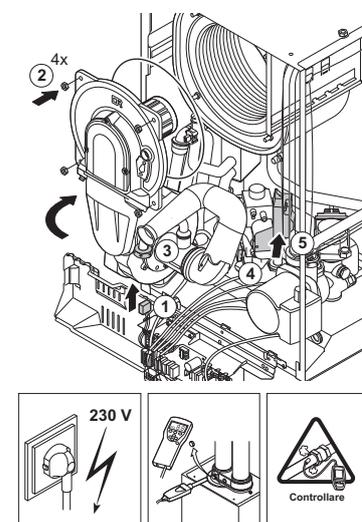
Assemblaggio della caldaia
