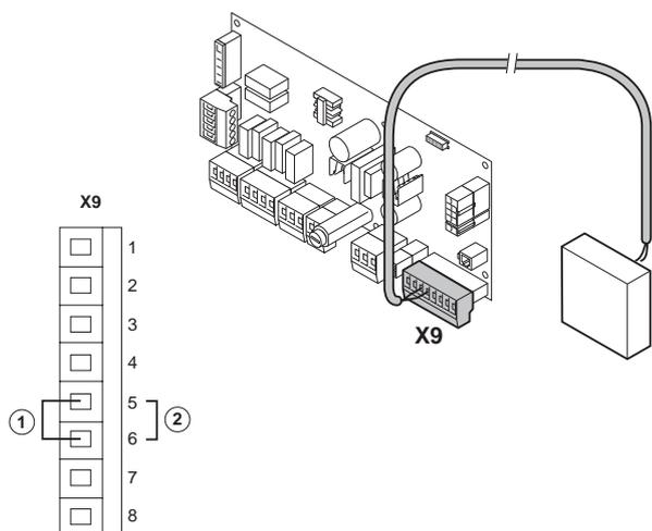
Schema elettrico di un interblocco esterno
