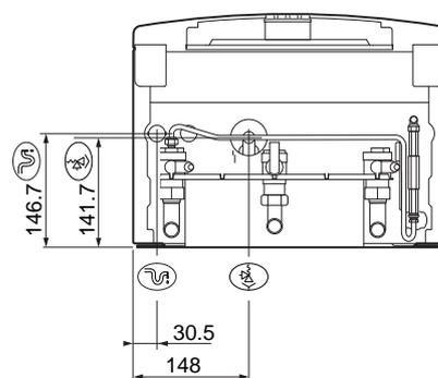
Dimensioni e punti di collegamento della ModuStar Solo
