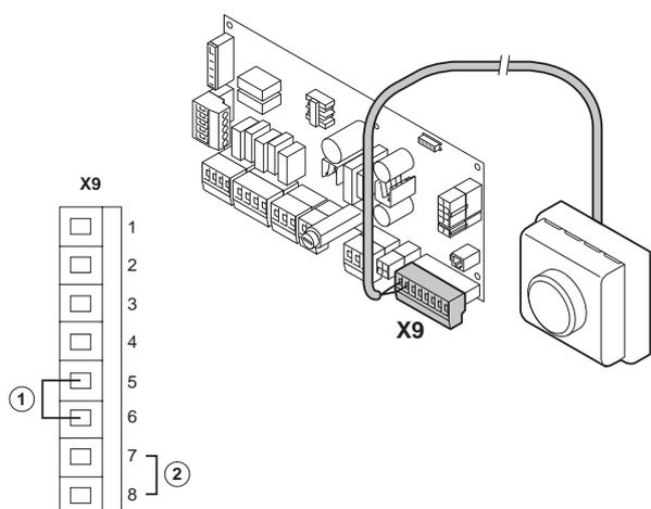
Schema elettrico del dispositivo antigelo
