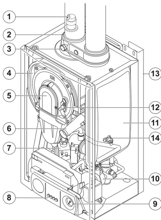
Componenti della caldaia ModuStar
