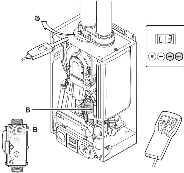
Controllo del comando del rapporto gas/aria – impostato su carico parziale – regolazione del rapporto gas/aria B sul blocco del gas
