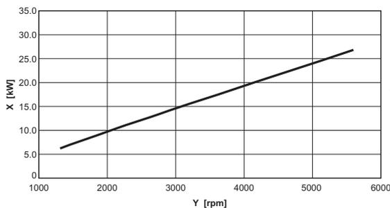
Rapporto velocità ventilatore / potenza erogata caldaia ModuStar 28c
