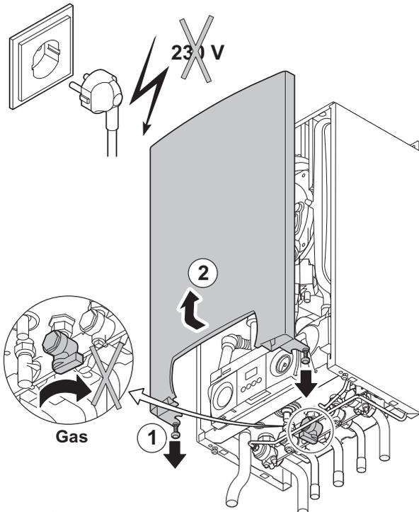
Apertura della caldaia
