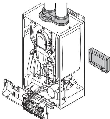
Controllo dei collegamenti elettrici e del termostato
