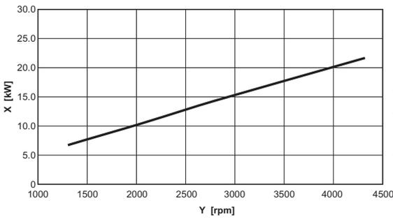
Rapporto velocità ventilatore / potenza erogata caldaia ModuStar 24s
