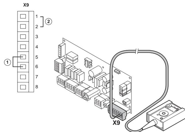
Schema elettrico della sonda di temperatura esterna
