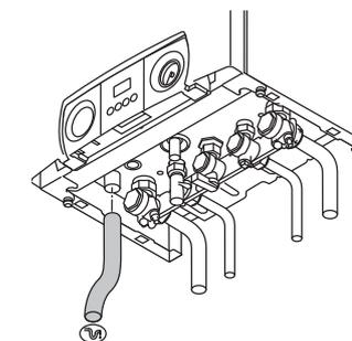
Collegamento dello scarico condensa (con dima optional)
