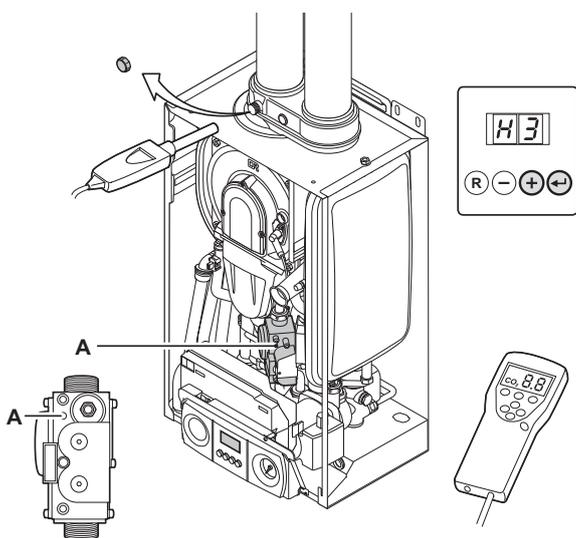
Controllo del comando del rapporto gas/aria – impostato su pieno carico – regolazione del rapporto gas/aria A sul blocco del gas
