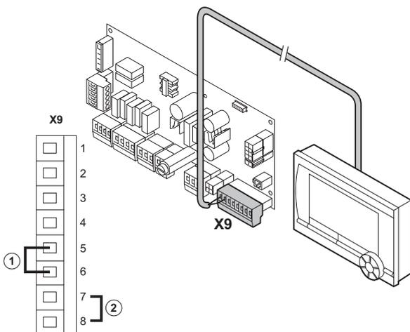
Schema elettrico del regolatore modulante
