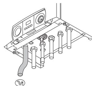
Collegamento dello scarico condensa (standard)
