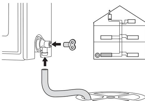
Collegamento del flessibile di scarico
