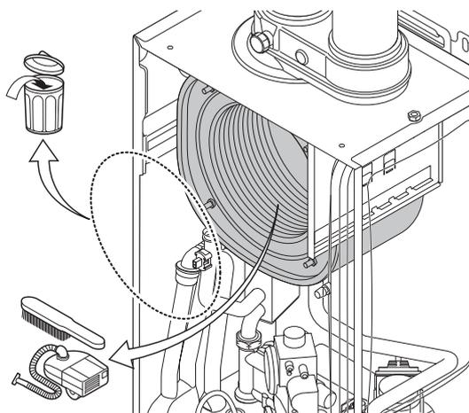
Manutenzione dello scambiatore di calore
