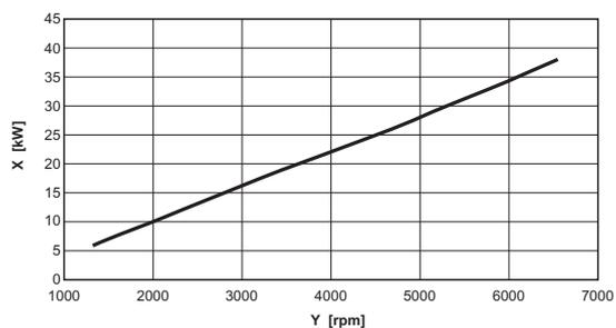
Rapporto velocità ventilatore / potenza erogata caldaia ModuStar 35c
