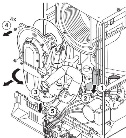
Smontaggio della piastra anteriore dello scambiatore di calore
