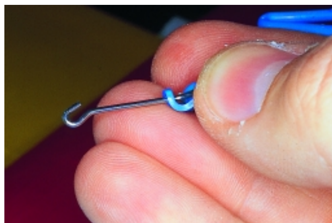
Fig. 24 - Piegatura sul filo della chiavetta per agganciare l'occhiello del bottone
