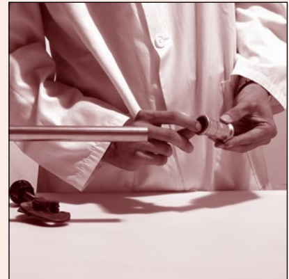
Fig. 23 | Verifica della presenza e del posizionamento degli o-ring Checking the presence and positioning of o-rings
