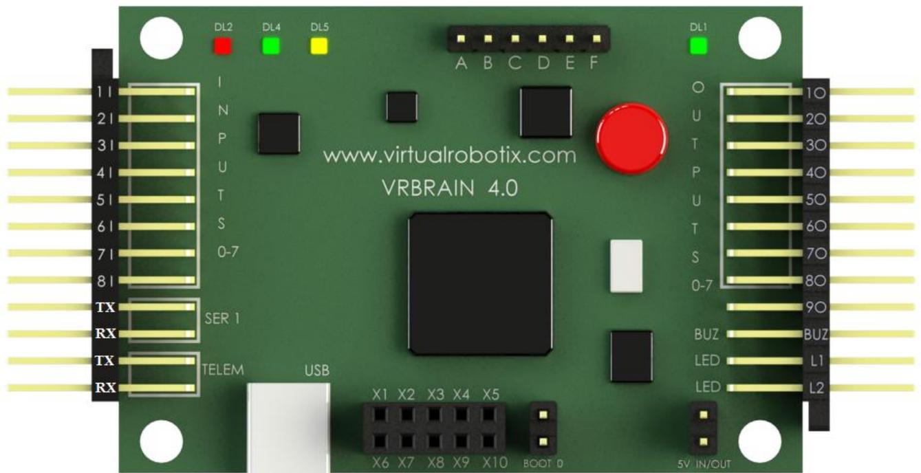
BUZ- si può collegare un buzzer, che segnala un allarme, es: BATTERIA SCARICA, oppure segnala con un doppia coppia di bip (bip-bip, bip-bip) l'avvenuta armatura dei motori (il gas è abilitato al secondo bip-bip) Quando si disarma viene emesso un singolo bip.
