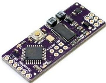
Questa è una scheda di espansione(OSD) che legge i dati del protocollo MAVLINK di telemetria e li sovrappone al flusso video se si sta usando una telecamera e trasmissione wireless. Questo è utile se si sta volando in FPV e non si usa il pc portatile per vedere i dati telemetrici con MP. Non è possibile usare l'OSD quando la VRB è collegata al pc con cavo USB, perché condividono la stessa porta. Scollegare il cavo USB prima di usare l'OSD.
