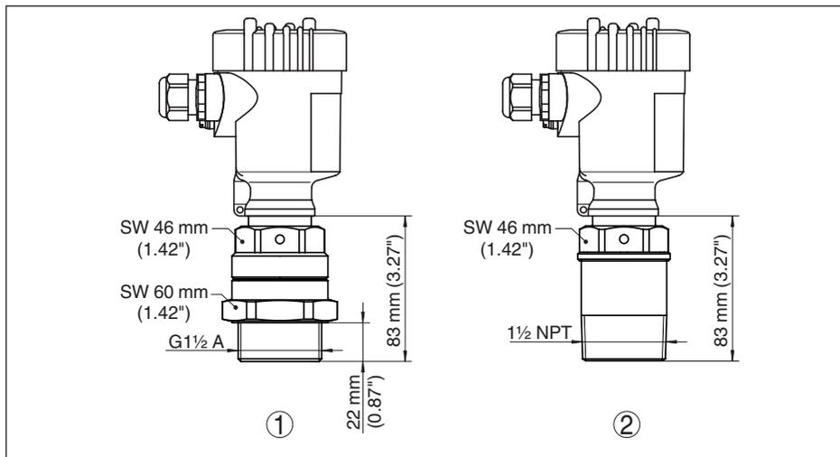
Figura 46: VEGAMIP 62, antenna a cono interna (esecuzione filettata)
