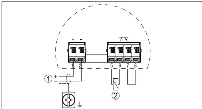
Figura 27: Schema elettrico elaboratore - VEGAMIP 62 (receiver) - comportamento NPN
