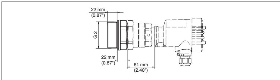
Figura 49: Adattatore di montaggio con copertura in ceramica (opzionale) per VEGAMIP 62 con antenna a cono interna, esecuzione filettata G1½ con protezione in PTFE (anche con filettatura NPT 1½)
