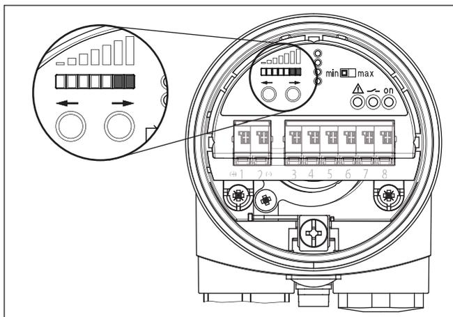
Figura 41: Serie di spie LED - Impostazione per prodotti con buona attenuazione del segnale
