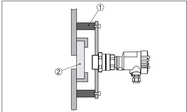
Figura 16: Installazione in presenza di vibrazioni del serbatoio
