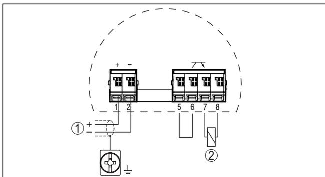
Figura 26: Schema elettrico elaboratore - VEGAMIP 62 (receiver) - comportamento PNP
