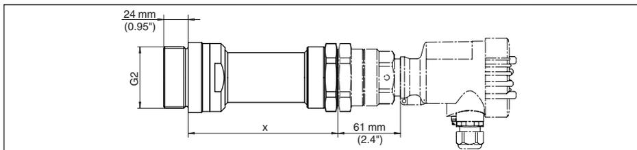
Figura 50: Adattatore di montaggio con copertura in ceramica (opzionale) per VEGAMIP 62 con antenna a cono interna, esecuzione filettata G1½ con protezione in PTFE (anche con filettatura NPT 1½)
