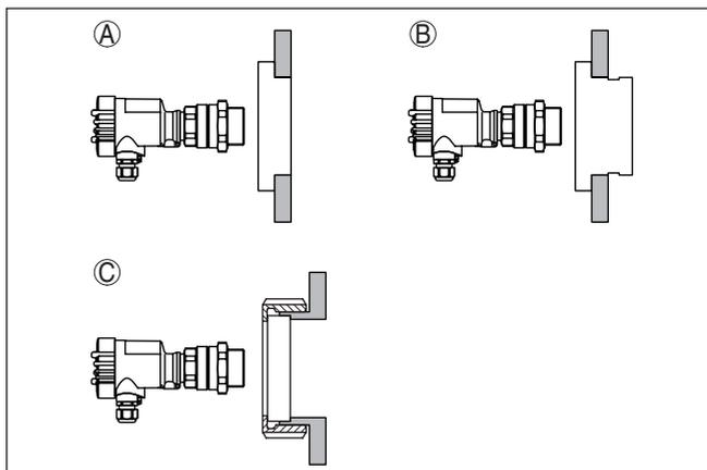
Figura 8: Montaggio davanti a una finestra del serbatoio
