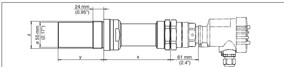
Figura 51: Adattatore di montaggio con tubo (opzionale) per il montaggio affiancato, per VEGAMIP 62 con antenna a cono interna, esecuzione filettata G1½ con protezione in PTFE (anche con filettatura NPT 1½)
