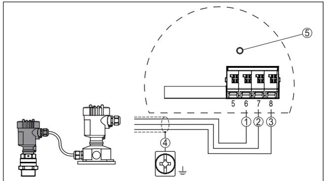
Figura 24: Collegamento della linea nella custodia del sensore
