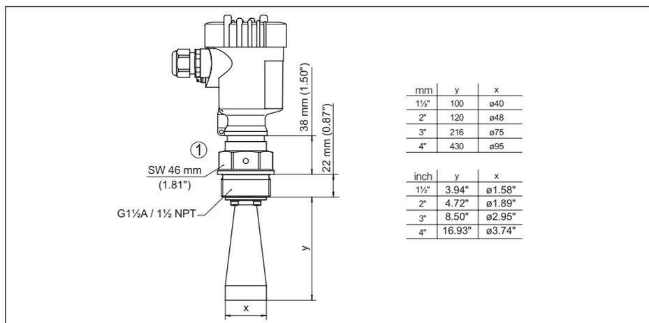
Figura 48: VEGAMIP 62, antenna a cono (316L)
