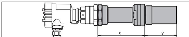
Figura 5: VEGAMIP 62 con adattatore di montaggio per alta temperatura con tubo -40 ... +450 °C (-40 ... +842 °F)
