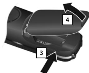
Se è necessario **aprire nuovamente il coperchio delle batterie**, ad es. per cambiare le batterie:
