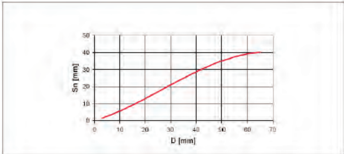
Figura 1.4: Legame tra diametro della bobina e raggio d'azione nominale per sensori induttivi standard
