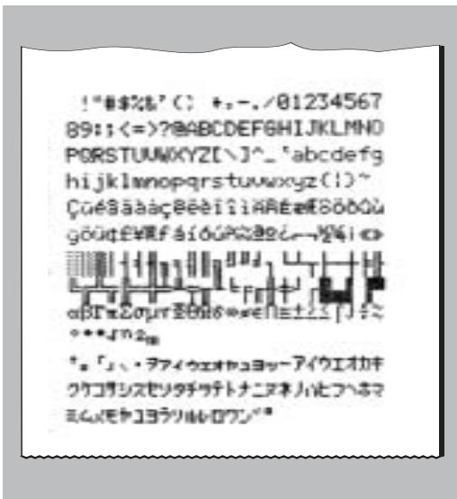
La LC-P43 è dotata d'una funzione di autodiagnosi, che provoca la stampa automatica del set di caratteri della stampante.
