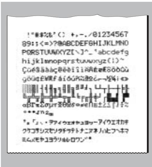
Der LC-P43 besitzt einen Selbst-Test, der automatisch den Zeichensatz des Druckers ausdruckt.
