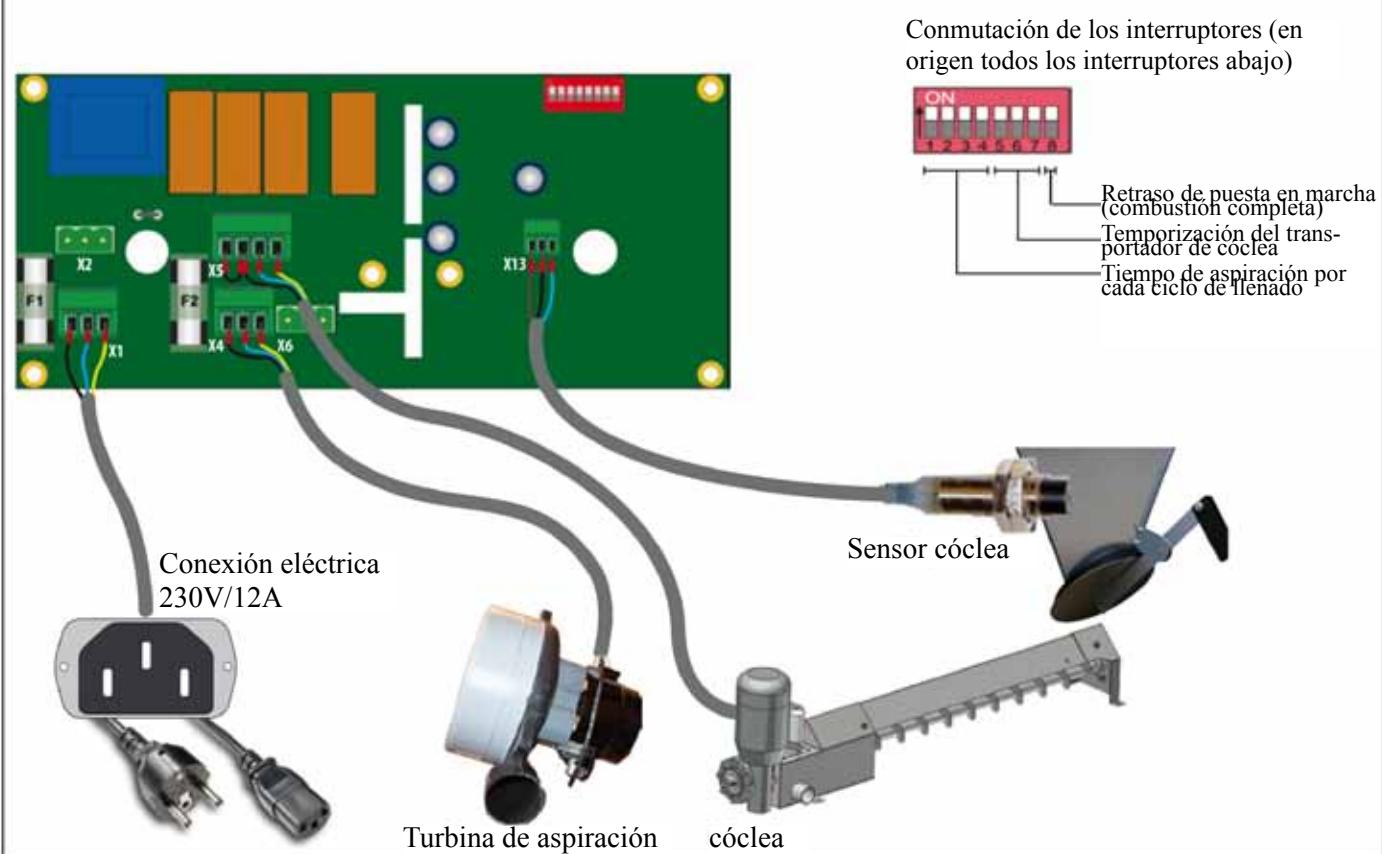
La alimentación eléctrica es conectada mediante el cable del refrigerador adjunto (cable eléctrico). El transportador de cóclea es conectado en el conector X5.
