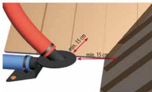
Der Schrägboden muss mit mindestens  $45^\circ$  aufgebaut werden. Der Abstand vom Rand des Saugpunktes muss mindestens 15 cm zu dem Schrägboden oder zu einer Wand betragen.
