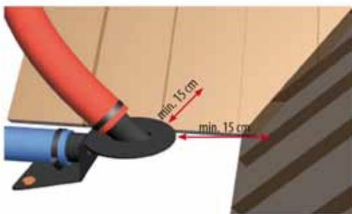
Le plan incliné doit être réalisé au moins à un angle de 45°. La distance du bord du point d'aspiration doit être au moins de 15 cm vers le plan incliné ou vers une paroi.
