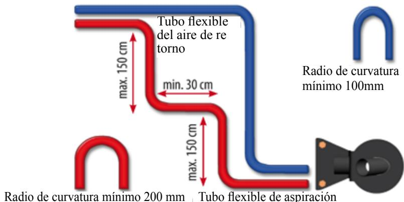
La estructura por planos del tubo flexible de aspiración es necesaria solo en caso de punto de aspiración.
