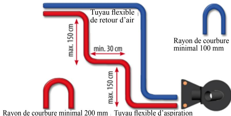
La structure par étages du tuyau flexible d'aspiration est nécessaire seulement en cas de point d'aspiration.
