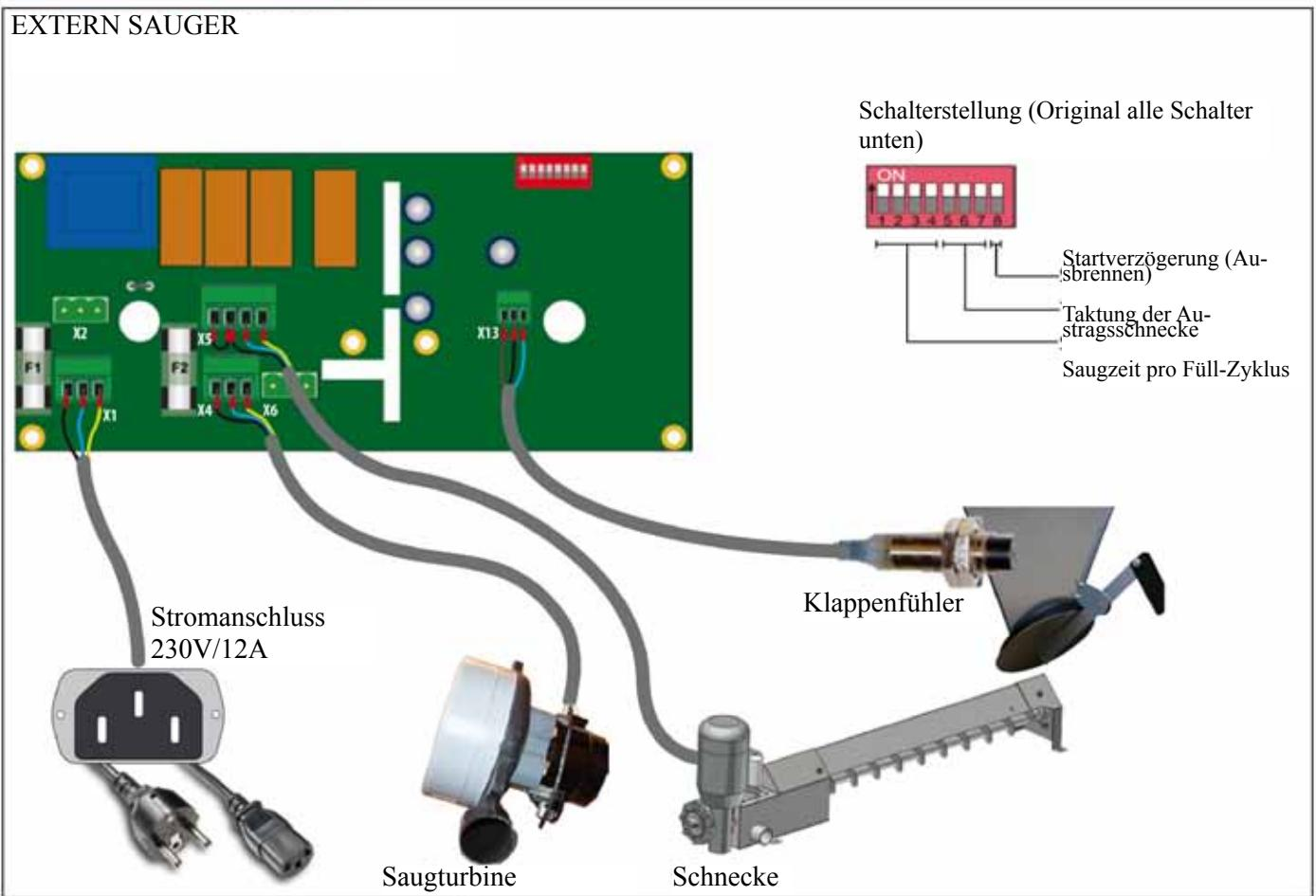
Die Stromversorgung wird über das beigelegte Kaltgerätekabel (Stromkabel) angeschlossen. Die Austragungsschnecke wird am Stecker X5 angeschlossen.
