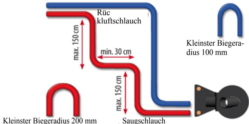
Die Etagierung des Saugschlauches ist nur bei einem Saugpunkt nötig.
