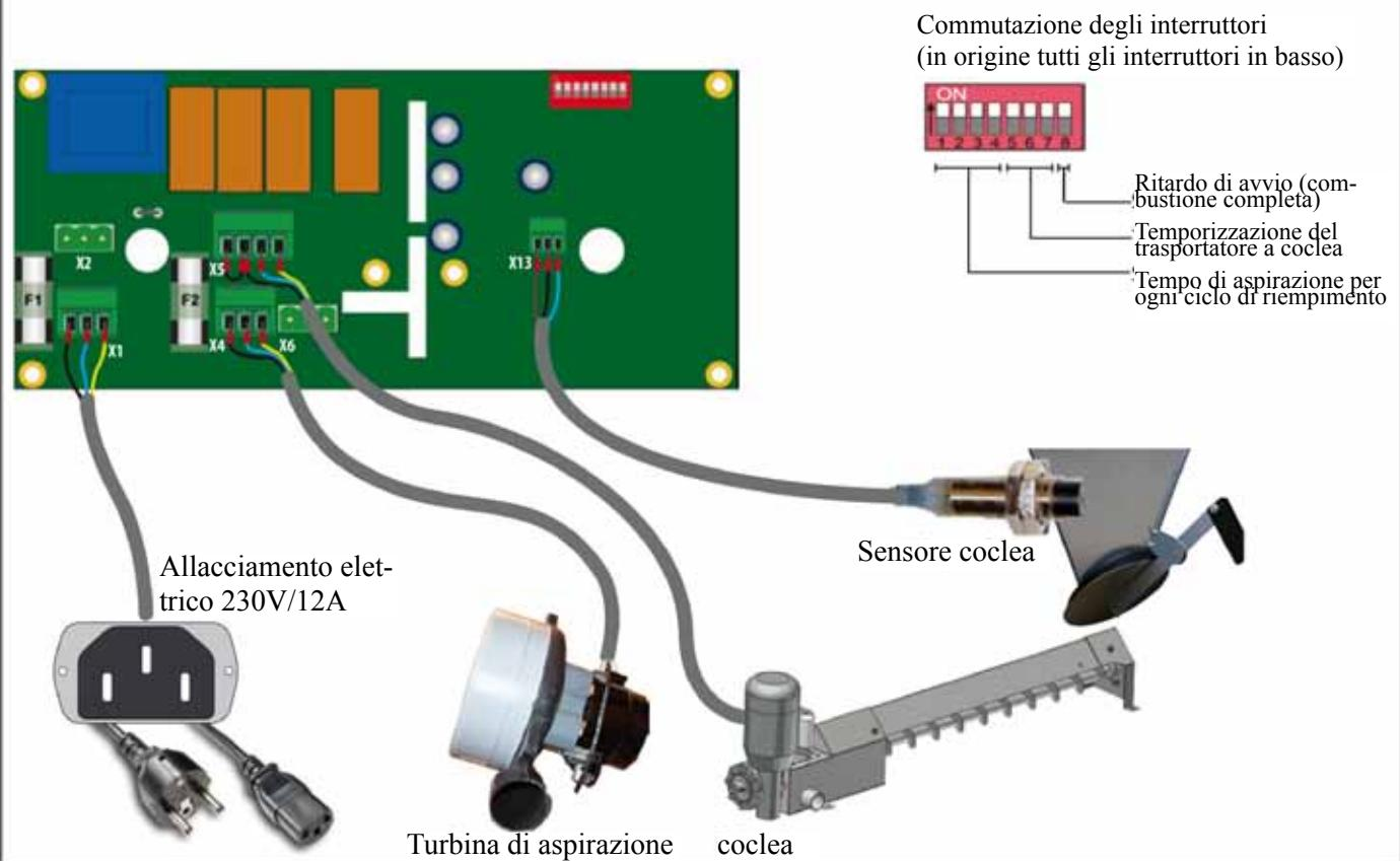
L'alimentazione elettrica viene collegata mediante il cavo del refrigeratore allegato (cavo elettrico). Il trasportatore a coclea viene collegato sul connettore X5.
