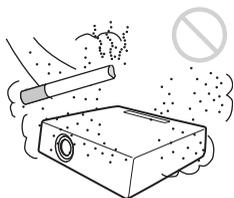
Non installare l'apparecchio in un ambiente molto polveroso o fumoso. Diversamente il filtro dell'aria potrebbe intasarsi e causare un malfunzionamento o un guasto dell'apparecchio. L'aria potrebbe non passare attraverso il filtro a causa della polvere e provocare un aumento della temperatura interna dell'apparecchio. Pulire il filtro periodicamente.
