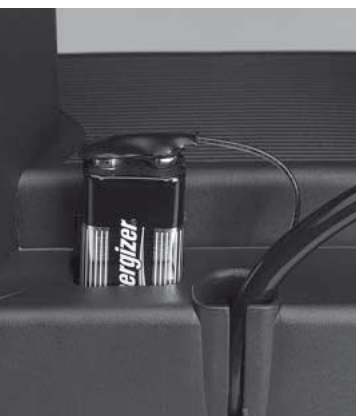
Blocchi di batterie da 9 V per l'abbassamento d'emergenz
