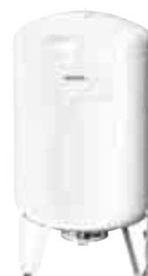
Il valore di precarica del vaso di espansione sarà 0,3 – 0,5 bar inferiore alla pressione P<sub>i</sub>.
