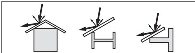
Figura 10: Copertura di profili piatti mediante deflettori
