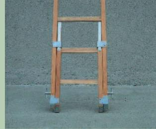
*Esempio di scala con dispositivi anti-sdrucchiolevoli*
