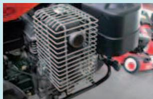
*Isolamento del tubo di scarico*
