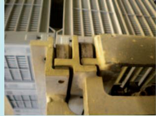
*Carrello montante mobile sprovvisto di blocco di fine corsa*
