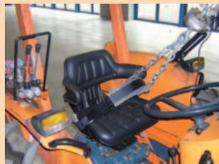
*Prova in tensione della cintura di sicurezza*
