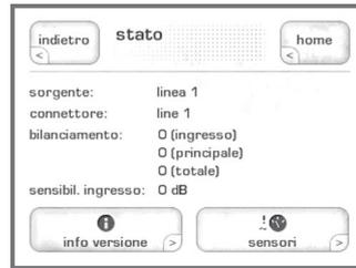
Il menu **status** visualizza diverse informazioni sullo stato attuale di funzionamento del CAP-2100; vi permette inoltre di accedere al menu *version info*, che contiene informazioni sulla versione software, ed al menu *sensor* che indica lo stato dei sensori che controllano la temperatura e la tensione di alimentazione del CAP-2100.
