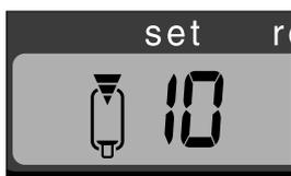
I: Quando appare la spia FUEL, verranno mostrati sul display informativo i minuti di funzionamento che ancora rimangono alla stufa in base alla quantità di combustibile rimasta nel serbatoio.
