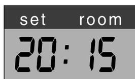
E: Nel momento in cui i quattro numeri smettono di lampeggiare, la stufa è stata programmata secondo i dati impostati.
