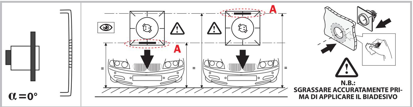
**N.B.:** PER UN CORRETTO FUNZIONAMENTO, ACCERTARSI CHE IL RIFERIMENTO (A) DI POSIZIONAMENTO SIA ORIZZONTALE AL TERRENO. DOPO L'APPLICAZIONE AL PARAURTI NON BAGNARE O SFORZARE PER LE SUCCESSIVE 8 ORE.
