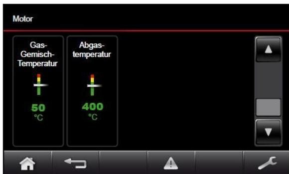
Fig. 19 Schermate operative Motore
