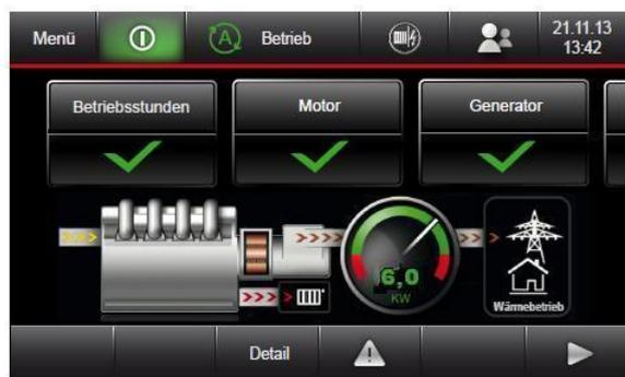
Fig. 4 Schermata base del quadro di comando e di segnalazione con il "segno di spunta Tutto OK"
