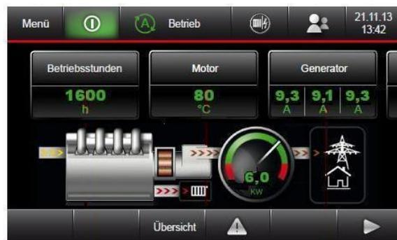
Fig. 5 Schermata base del quadro di comando e di segnalazione con dettagli
