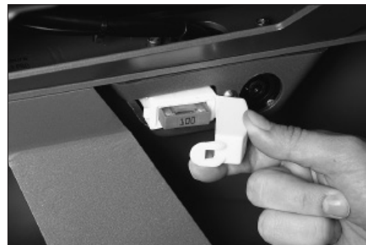
fig. 36 Sostituzione del fusibile
