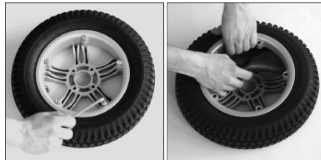
fig. 39 Smontaggio del copertone
