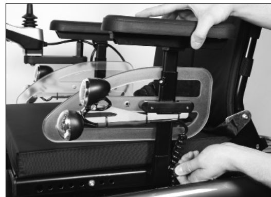
fig. 9 Allentamento della vite ad alette per la rimozione della spondina con bracciolo
