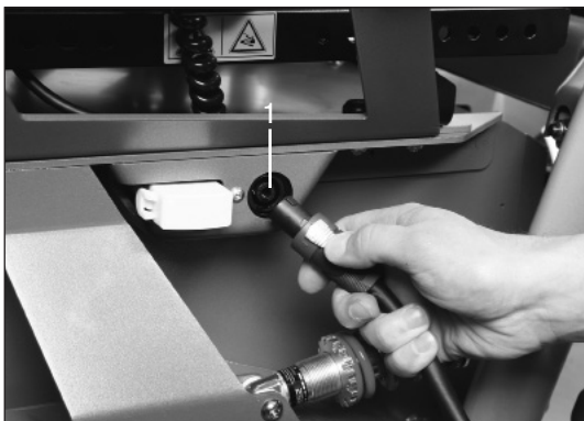
fig. 22 Collegamento del caricabatteria al connettore di carica
