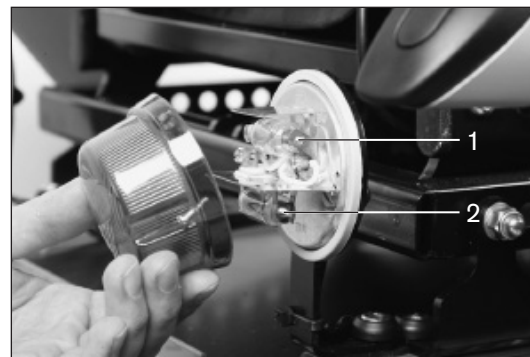
fig. 42 Smontaggio dell'impianto di illuminazione posteriore
