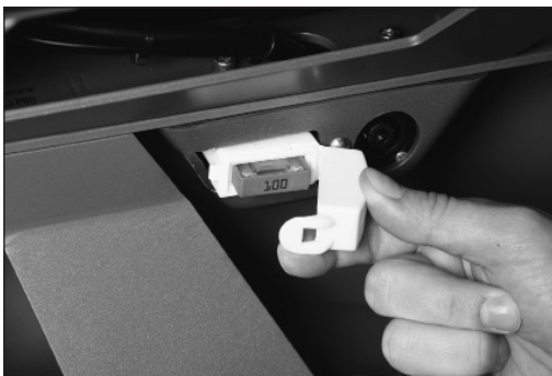
fig. 3 Portafusibile con fusibile inserito
