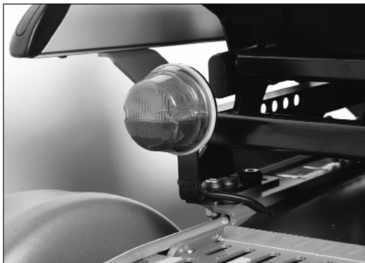
fig. 20 Impianto di illuminazione posteriore
