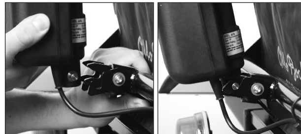
fig. 4 Inserimento del perno trasversale nel supporto, perno trasversale bloccato
