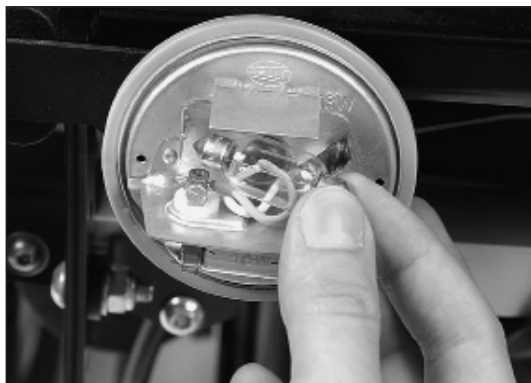
fig. 43 Sostituzione della lampadina del lampeggiatore
