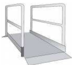
Fig. 2657 art. 40 – Passerella pedonale con parapetti
