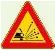
Fig. 390 art. 31 – Materiale instabile sulla strada
