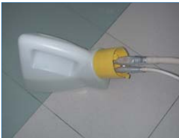
19. È necessario provvedere alla sanificazione delle tubature facendo aspirare a ogni trattamento un litro di soluzione contenente prodotti specifici.
