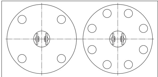
Figura 6: Posizione del diapason nelle versioni a flangia
