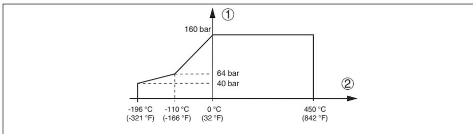
Figura 46: Temperatura di processo - pressione di processo - esecuzione fino a 160 bar (2321 psig)
