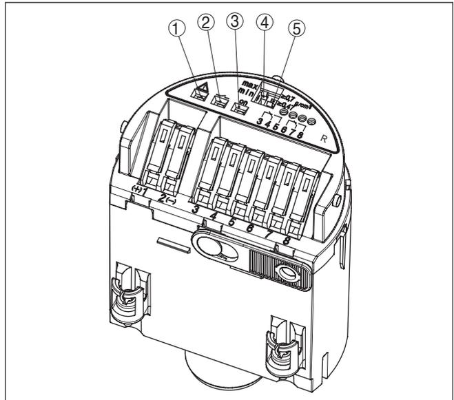
Figura 14: Unità elettronica - Uscita a relè
