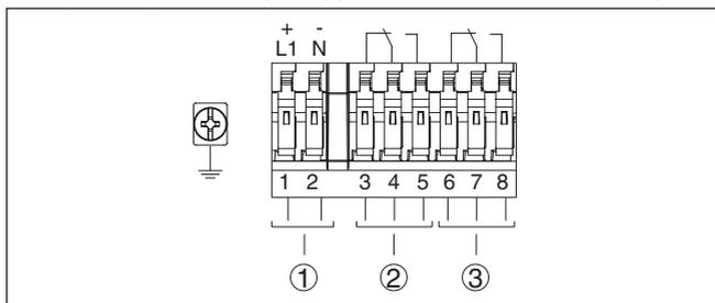
Figura 13: Schema elettrico custodia a una camera
