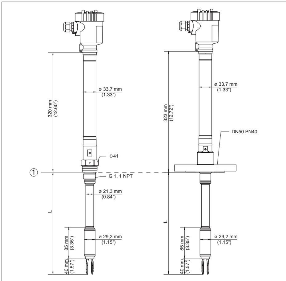
Figura 50: VEGASWING 66, esecuzione a tubo
