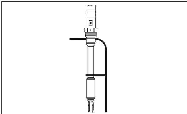
Figura 10: Sostegno laterale del VEGASWING 66
