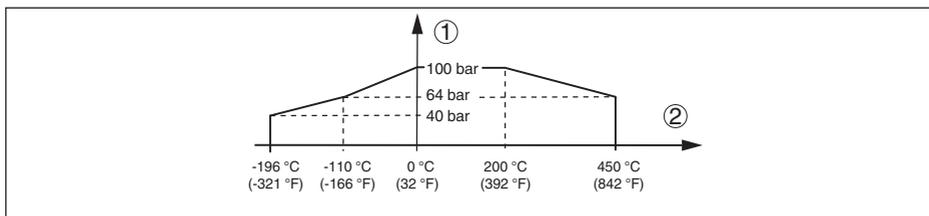
Figura 45: Temperatura di processo - pressione di processo - esecuzione fino a 100 bar (1450 psig)
