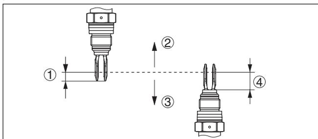
Figura 3: Montaggio verticale
