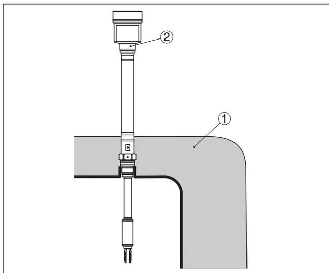
Figura 8: Montaggio dell'apparecchio su un serbatoio isolato.
