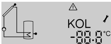
Corto circuito sensore temperatura collettore
