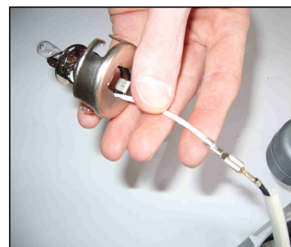
Figura 12 – Rimozione della lampada.
