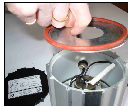
Figura 10 – Estrazione del setto di protezione.
