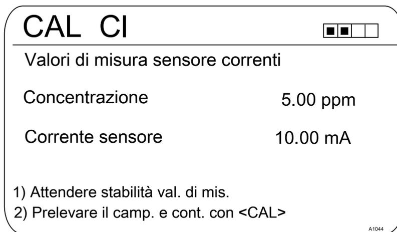
*Fig. 18: Calibrazione del valore di riferimento: valori correnti del sensore*
