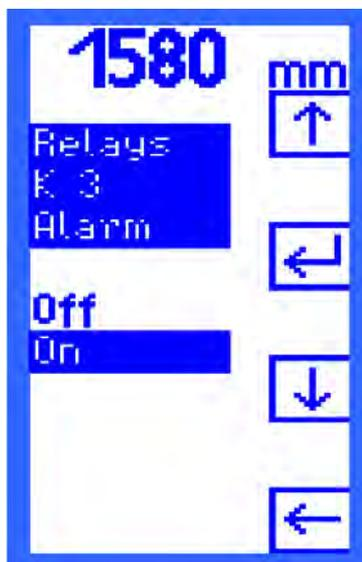
Nel menu di impostazione «Alarm» (Allarme) si può impostare l'allarme relè tramite le funzioni
