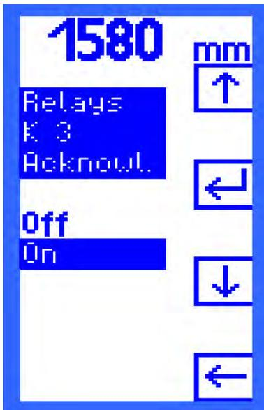
La possibilità di riarmare il relè in caso di allarme si può impostare individualmente per ciascun relè. Tramite le funzioni
