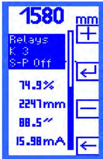
Il menu di impostazione «S-P Off» (Switching Point Off) indica il valore di diseccitazione del relè.
