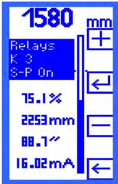
Il menu di impostazione «S-P On» (Switching Point On) indica il valore di eccitazione del relè.
