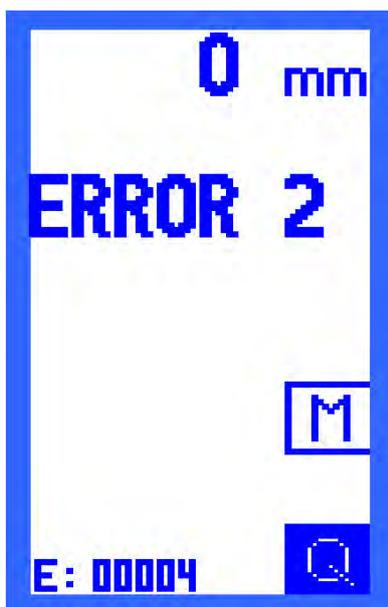
In caso di errore il LED lampeggia periodicamente (0,1 sec. acceso, 0,9 sec. spento), il cicalino suona e il codice errore compare sul display.
