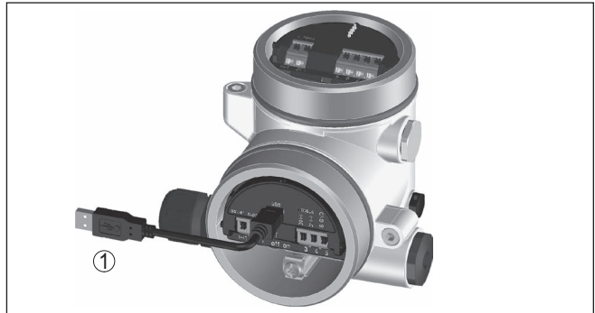
Figura 37: Collegamento del PC all'elettronica Modbus via USB
