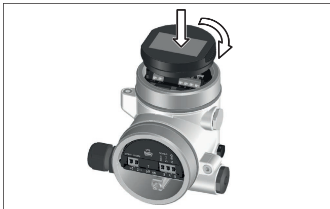
Figura 33: Inserzione del tastierino di taratura con display
