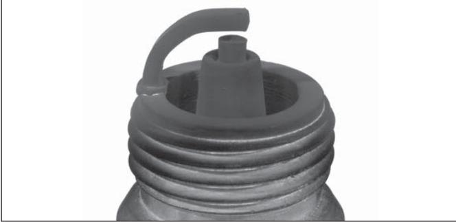
depositi neri, soffici e fuliginosi indicano una combustione incompleta, generalmente dovuta a un filtro dell'aria intasato, una miscela troppo ricca, problemi di accensione o scarsa compressione.
