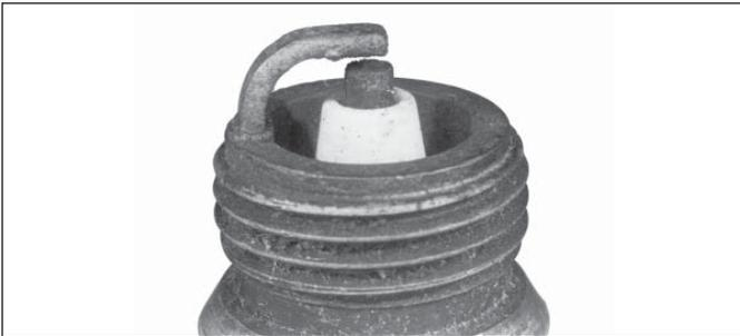
Depositi bianchi gessosi indicano temperature di combustione estremamente elevate ed in genere sono accompagnati da un'erosione eccessiva della distanza tra gli elettrodi. Le cause possono essere miscela troppo povera, perdita d'aria in aspirazione o fasatura errata.
