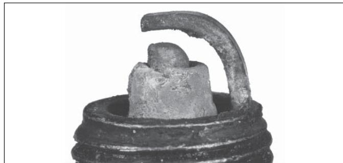
In una candela usurata, l'elettrodo centrale sarà arrotondato e la distanza tra gli elettrodi sarà superiore al valore di specifica. Una candela usurata deve essere immediatamente sostituita.
