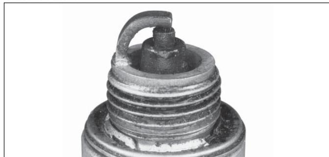
Una candela può essere bagnata da una quantità eccessiva di olio o carburante nella camera di combustione. La quantità eccessiva di carburante può essere dovuta a un filtro dell'aria intasato, un problema al carburatore o un utilizzo eccessivo dello starter. L'olio nella camera di combustione è generalmente dovuto a un filtro dell'aria intasato, un problema di sfiato oppure a segmenti dei pistoni, pareti dei cilindri o guide delle valvole usurati.
