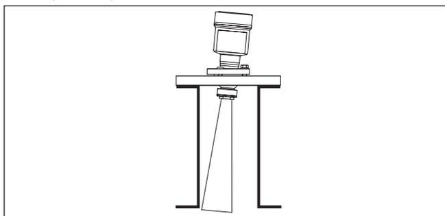
Figura 11: Distanza tra antenna e tronchetto in caso di antenna a cono
