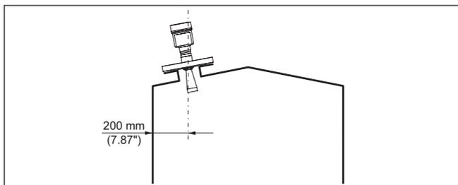
Figura 6: Montaggio del sensore radar sul cielo del serbatoio
