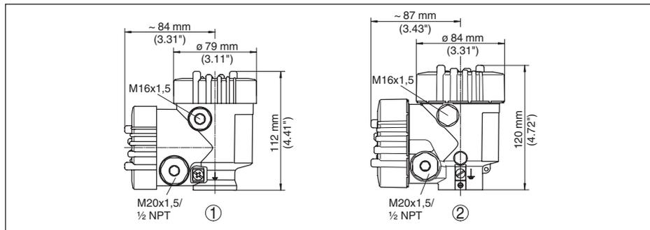
Figura 47: Dimensioni custodia - con tastierino di taratura con display incorporato l'altezza della custodia aumenta di 9 mm/0.35 in
