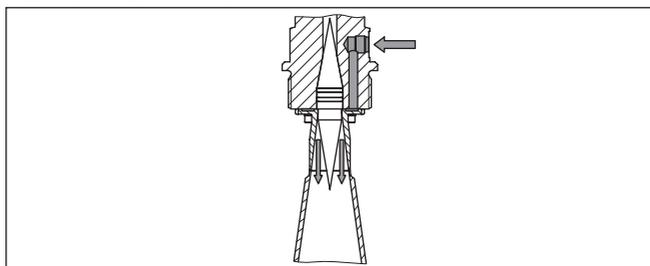
Figura 23: Attacco per purga d'aria/lavaggio periodico in un antenna a cono
