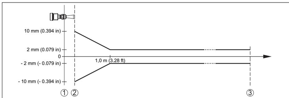
Figura 46: Scostamento di misura sotto condizioni di riferimento
