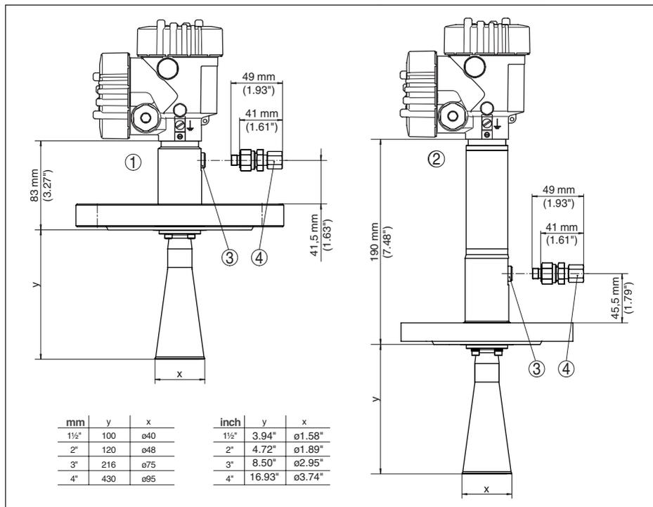
Figura 50: VEGAPULS 68, antenna a cono in esecuzione a flangia con attacco per purga d'aria
