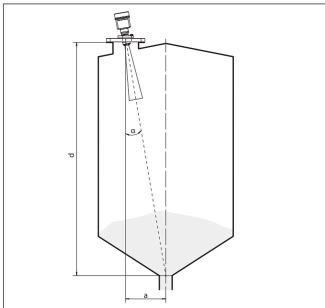
Figura 15: Presentazione di installazione dopo orientamento del VEGAPULS 68
