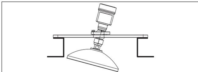
Figura 12: Distanza tra antenna e tronchetto in caso di antenna parabolica
