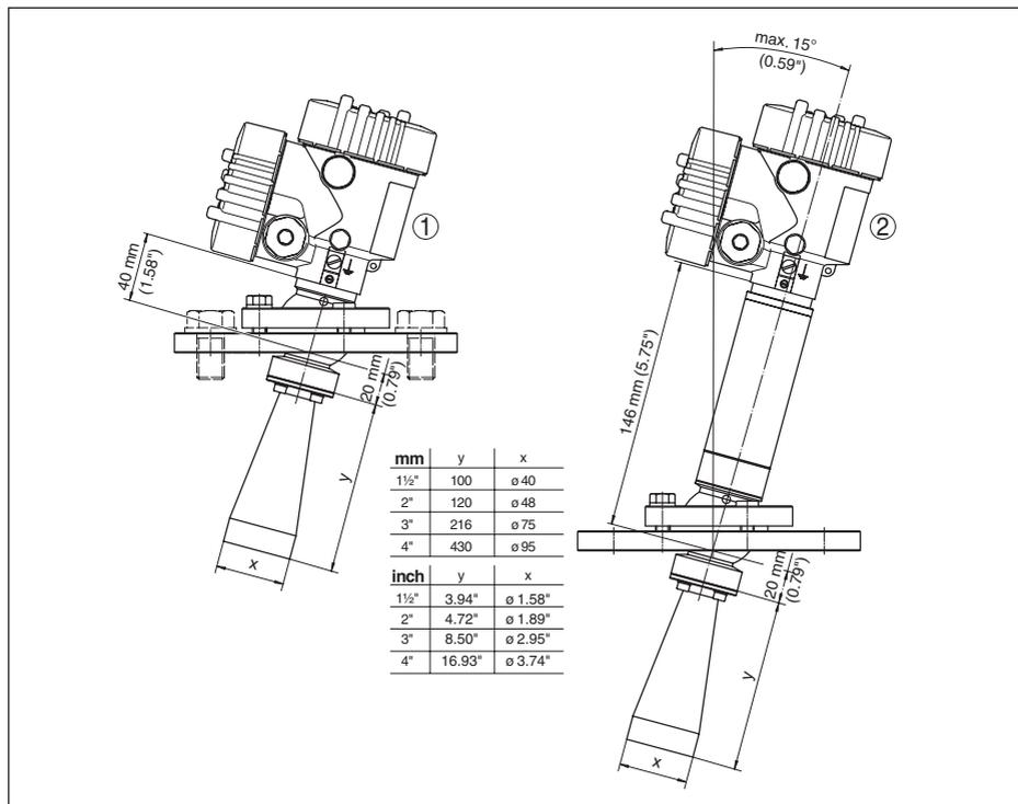
Figura 52: VEGAPULS 68, antenna a cono e supporto orientabile
