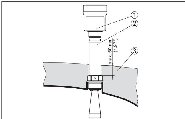
Figura 19: Montaggio dell'apparecchio su un serbatoio isolato.
