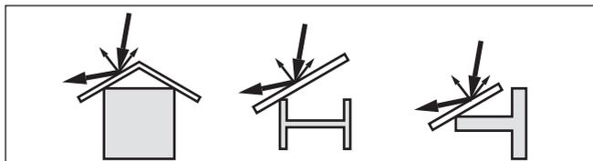
Figura 16: Copertura di profili piatti mediante deflettori
