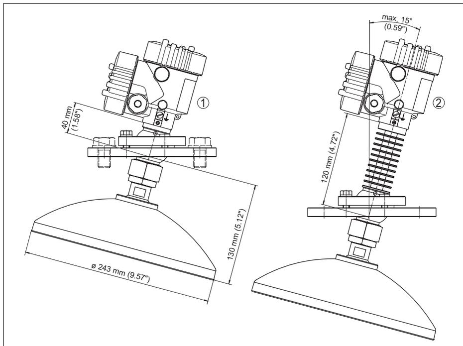
Figura 54: VEGAPULS 68, antenna parabolica e supporto orientabile
