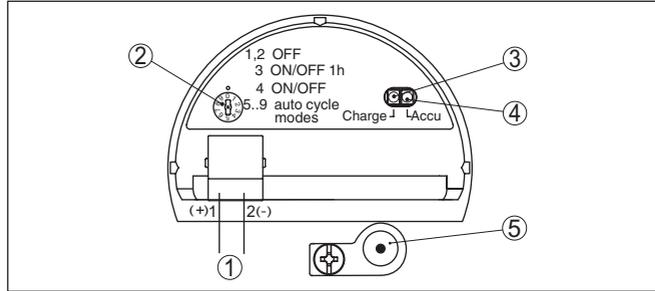
Figura 27: Vano di alimentazione
