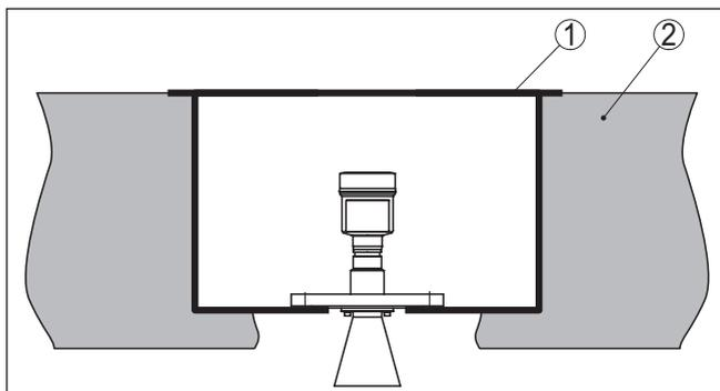
Figura 20: Montaggio dell'apparecchio in una cassa sotterranea
