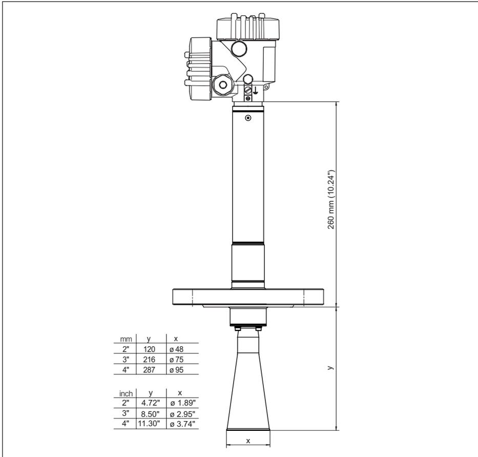
Figura 51: VEGAPULS 68, antenna a cono in esecuzione a flangia con pezzo intermedio per alte temperature fino a 450 °C
