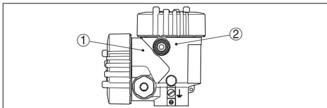
Figura 25: Posizione del vano di alimentazione e del vano dell'elettronica
