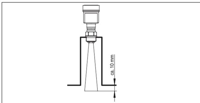
Figura 9: Per l'antenna a cono è consigliabile il montaggio con tronchetto
