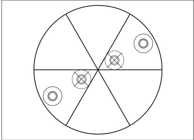
Figura 21: Montaggio del VEGAPULS 68 in silo multicamera
