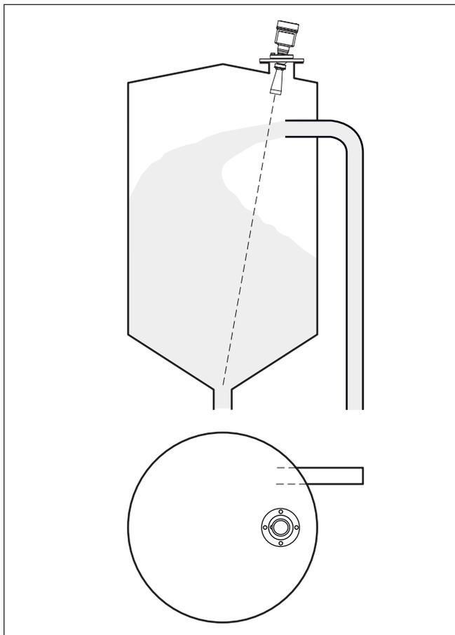
Figura 8: Montaggio del sensore radar in presenza del flusso di carico
