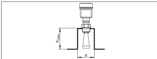
Figura 13: Massime dimensioni del tronchetto possibili
