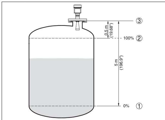
Figura 32: Esempio di parametrizzazione Taratura di min./max.
