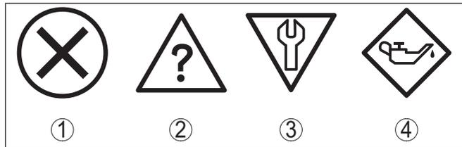
Figura 35: Pittogrammi delle segnalazioni di stato
