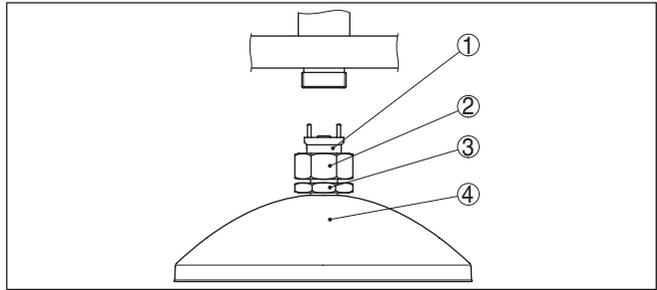
Figura 4: Smontaggio dell'antenna parabolica
