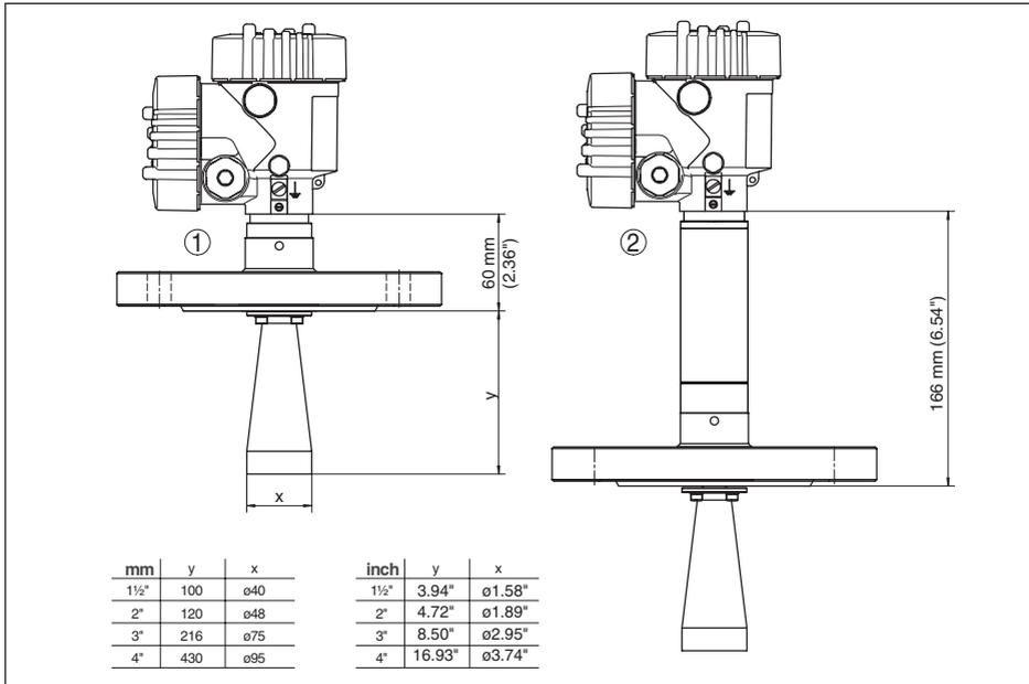
Figura 49: VEGAPULS 68, antenna a cono in esecuzione a flangia
