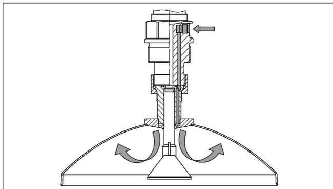
Figura 24: Attacco per purga d'aria/lavaggio periodico in un antenna parabolica
