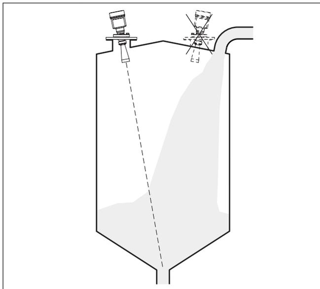
Figura 7: Montaggio del sensore radar in presenza del flusso di carico
