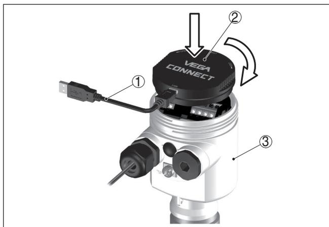
Figura 33: Collegamento diretto del PC al sensore via adattatore d'interfaccia
