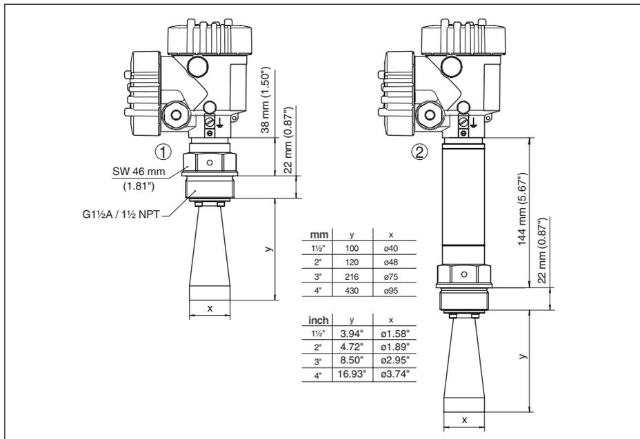
Figura 48: VEGAPULS 68, antenna a cono in esecuzione filettata
