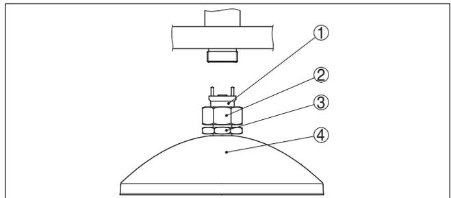
Figura 3: Smontaggio dell'antenna parabolica
