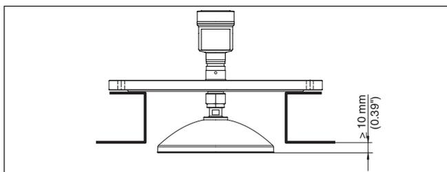
Figura 10: Per l'antenna parabolica è consigliabile il montaggio con tronchetto
