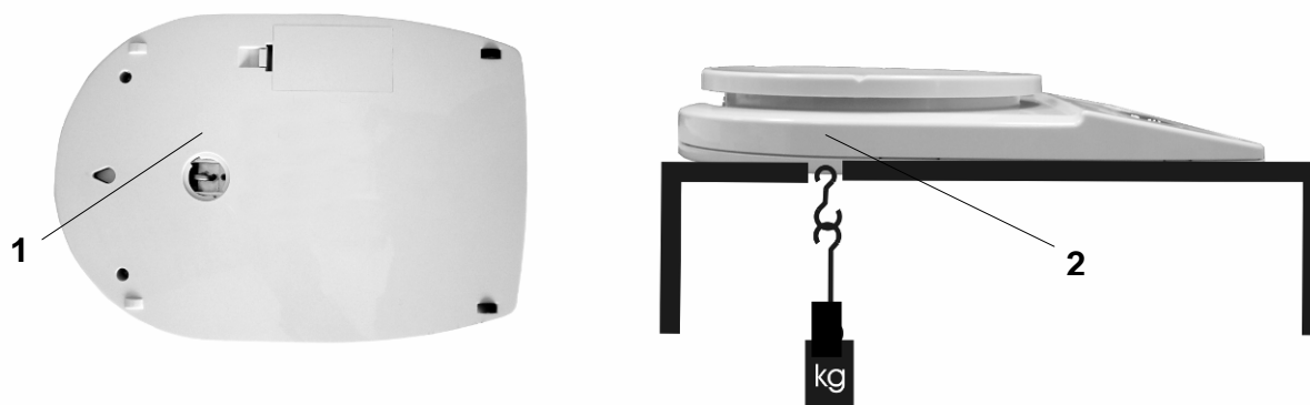
Fig. 1: Regolazione della bilancia per pesature sottobilancia
