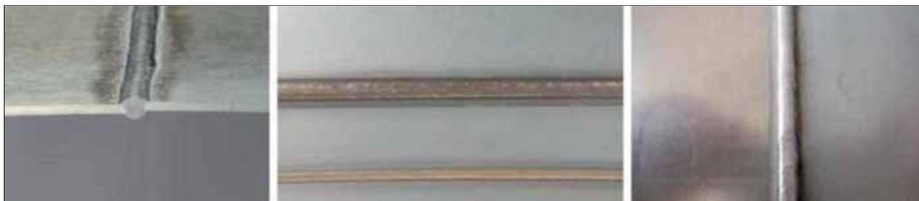
Figura 9 - Alcuni esempi di giunti eseguiti con CMT.
