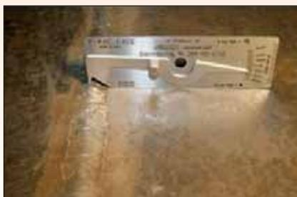
Figura 15 - Verifica dell'altezza di un cordone di saldatura in acciaio al carbonio.
