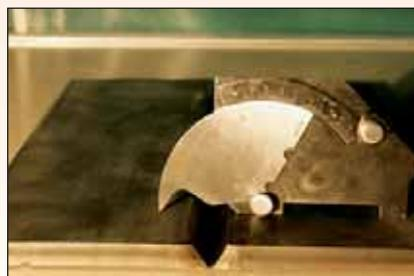
Figura 5 - Verifica corretto allineamento tra due cianfrini in acciaio inossidabile austenitico.
