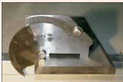
Figura 4 - Verifica angolo apertura di un cianfrino in acciaio inossidabile austenitico.
