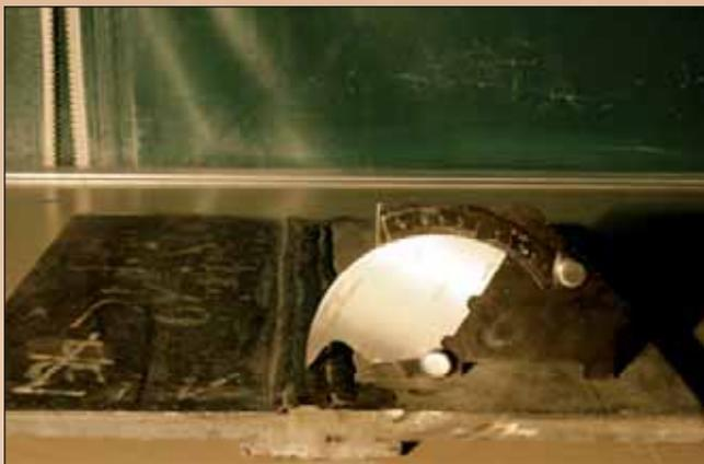
Figura 7 - Verifica del corretto deposito di materiale d'apporto su giunto saldato eterogeneo.
