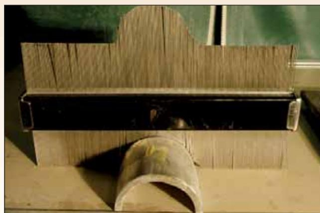
Figura 25 - Rilievo con profilometro (lunghezza 300 mm) su saldatura tra due tronchetti di diametro dissimile.
