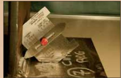
Figura 20 - Verifica dell'altezza di gola teorica su giunto saldato in acciaio al carbonio.
