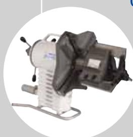
La soluzione più potente per la smussatura e l'intestatura di tubi. Consente di realizzare smussi per saldatura di alta precisione su estremità di tubi per mezzo del sistema placchetta-portaplacchette QTC®.
