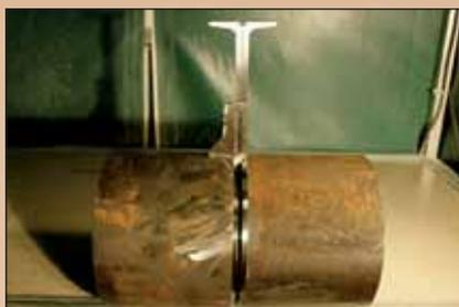
Figura 12 - Verifica angolo apertura di un cianfrino e allineamento su tronchetti in acciaio al carbonio.
