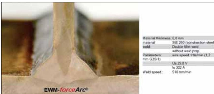
Figura 11 - Saldatura di un giunto a T con due passate (cortesia EWM).
