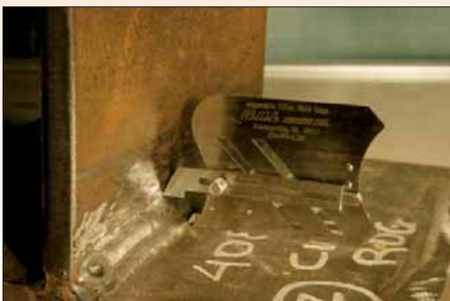
Figura 21 - Verifica del lato cordone di un giunto saldato in acciaio al carbonio.
