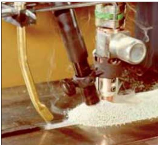
Figura 13 - Saldatura ad arco sommerso.
