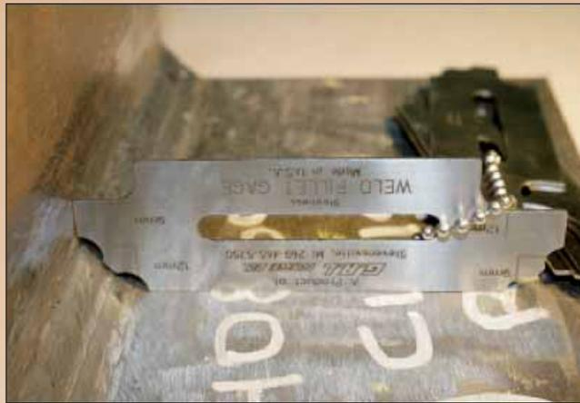
Figura 2 - Weld Fillet Gauge (calibro comparatore di concavità e convessità) - Ispezione su giunto a T in acciaio al carbonio, processo di saldatura a filo continuo.
