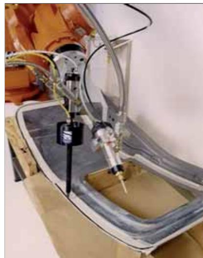
Figura 27 - Incollaggio robotizzato.
