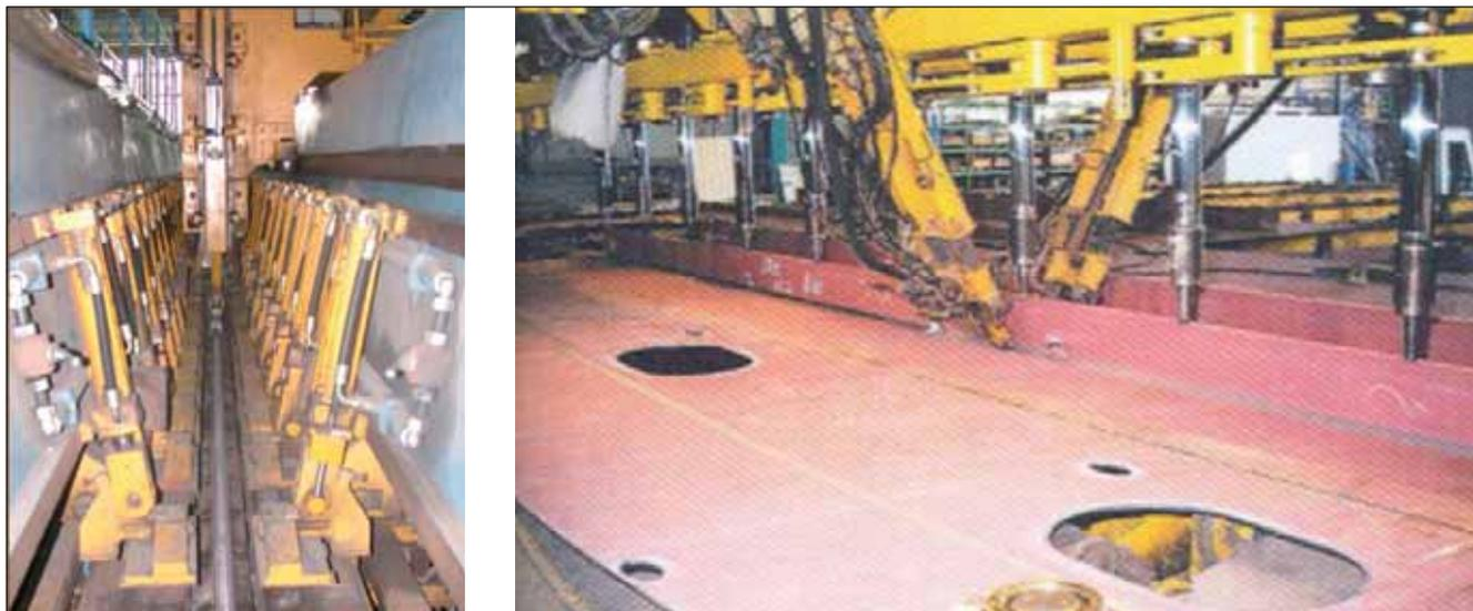
Figura 1bis - Impianti per la saldatura meccanizzata di strutture navali - Courtesy of Fincantieri SpA, Riva Trigoso (I).
