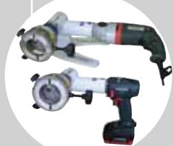
Macchine intestatrici per l'intestatura e la smussatura di tubi in acciaio inox di piccolo spessore e micro-fitting.
