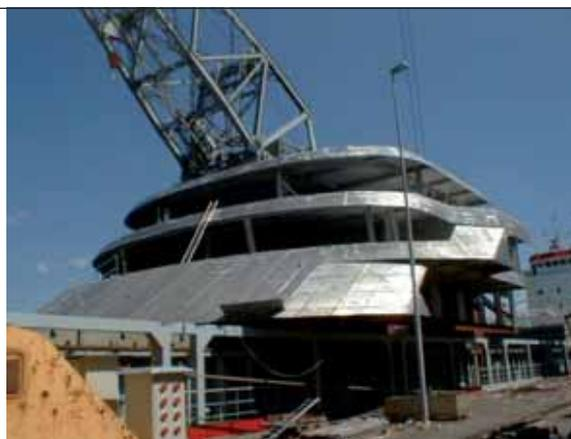
Figura 26 - Applicazione di saldatura FSW per pannellature e strutture navali (Courtesy of Marine Aluminium, NO).
