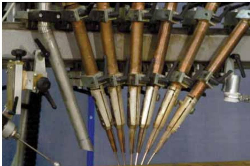
Figura 17 - Esempio di applicazione in arco sommerso multiwire per la saldatura longitudinale di tubi (ESAB LPR 4001).
