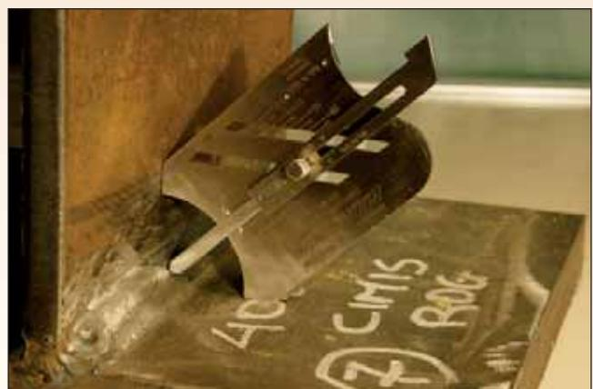
Figura 22 - Verifica dell'altezza di gola di un giunto saldato in acciaio al carbonio.
