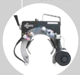
Saldatrici orbitali a testa aperta di nuova generazione. Lavorazioni con filo freddo e complete di controllo tensione d'arco (AVC) e pendolamento (OSC).
