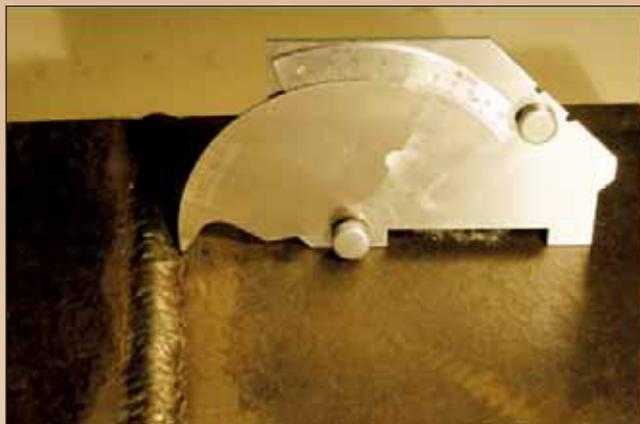
Figura 8 - Verifica altezza di un'incisione marginale su giunto saldato in acciaio al carbonio.
