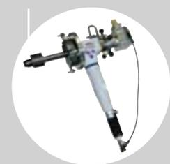
Macchina leggera e compatta per smussare i tubi per caldaia.
