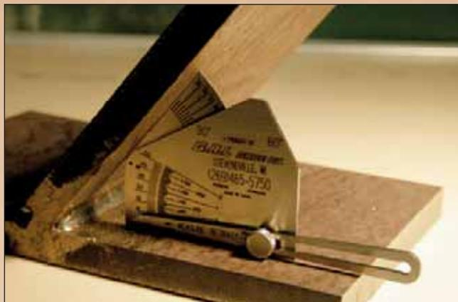
Figura 23 - Verifica, con accessibilità limitata, dell'angolo di un giunto saldato in acciaio al carbonio.
