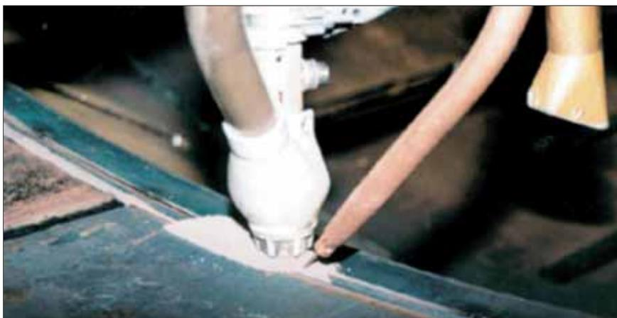
Figura 19 - Processo di saldatura a filo freddo.
