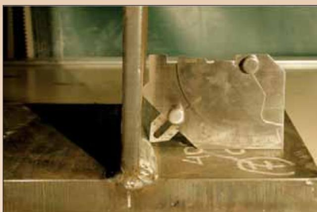
Figura 10 - Verifica dell'altezza di gola su giunto saldato a T in acciaio al carbonio.
