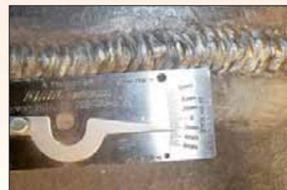
Figura 17 - Verifica di una soffiatura affiorante su giunto saldato in acciaio al carbonio.
