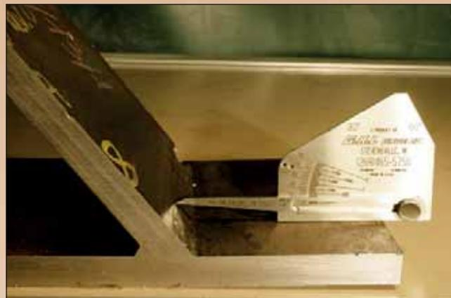
Figura 24 - Verifica dell'angolo ottuso di un giunto saldato in acciaio al carbonio.
