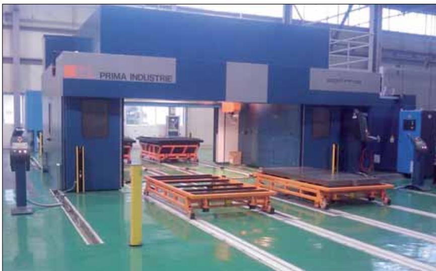
Figura 10 - Una cella robotizzata laser dal lato CNC.
