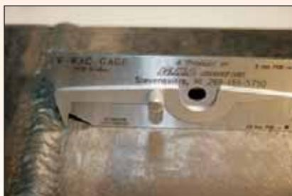
Figura 16 - Verifica dell'altezza di un'incisione marginale su giunto saldato in acciaio al carbonio.
