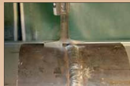
Figura 14 - Verifica errato allineamento tra due lembi in acciaio inossidabile austenitico.
