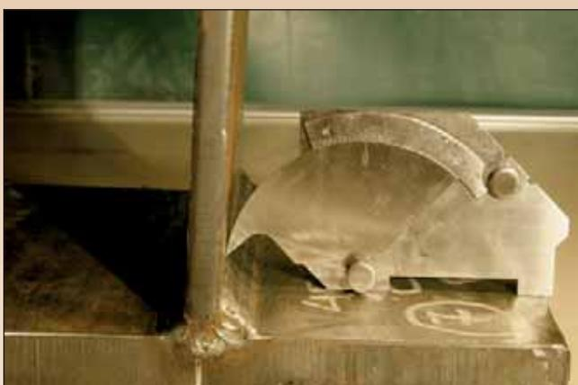
Figura 9 - Verifica del lato cordone su giunto saldato in acciaio al carbonio.
